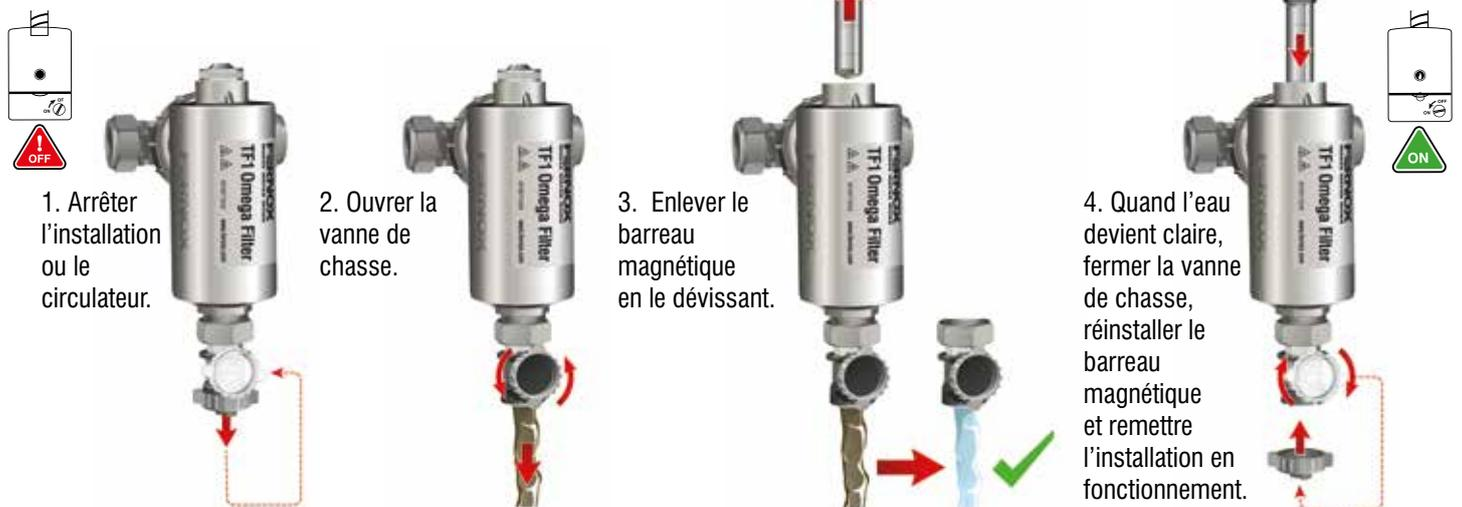
Le barreau magnétique doit toujours rester propre et sec.
