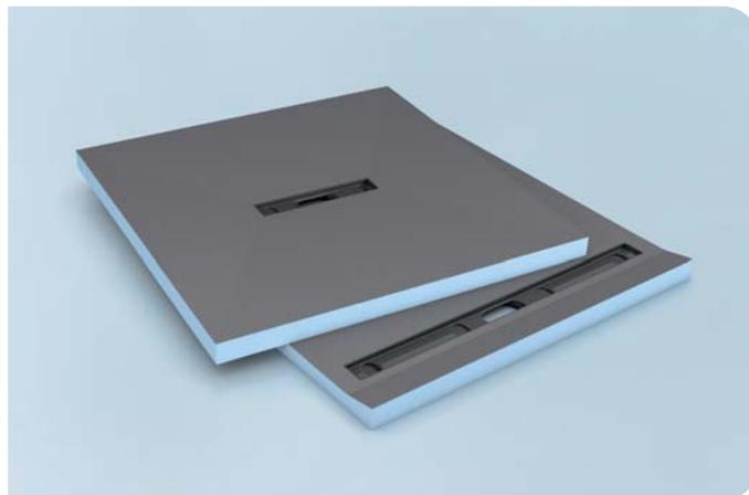
en fibres de verre et d'un enduit à base ciment. La forme de pente incorporée est de 2 % environ, suivant le modèle. Elle est réalisée en usine, par usinage au cours de la fabrication.
