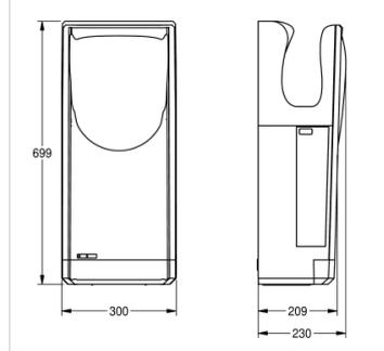
High Speed Händetrockner "Hands-in" für Aufputzmontage aus antibakteriellem ABS-Kunststoff, Farbe silber, Trocknungszeit 7-10 Sekunden, hygienisch dank berührungsloser opto-elektronisch gesteuerter Auslösung und integriertem HEPA Filter, Luftgeschwindigkeit einstellbar, optional Warm- oder Kaltluft, Selbstabschaltung nach 25 Sekunden, Wassertank- und Ablauf können separat gereinigt werden, Schutzart IPX4. Kabel und Stecker nicht im Lieferumfang enthalten.
