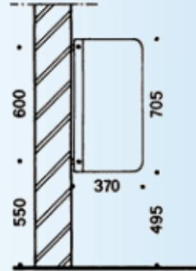
Les urinal screens blancs sont en aggloméré de bois stratifié, ennobli par stratification directe de films imprégnés de résine mélamine. Les chants visibles sont encollés d'une bande de mélamine stratifiée. La colle est du type thermodurcissable. Les profilés muraux sont en aluminium anodisé. Le screen est blanc.
