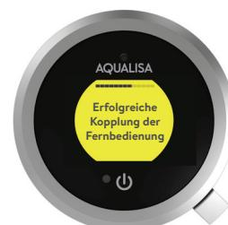
Drücken Sie den Hebel, um die Auswahl zu bestätigen. Sie werden aufgefordert, die Fernbedienungstaste zu drücken, bis die LED blinkt.
