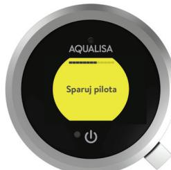
Naciśnij dźwignię, aby otworzyć tę opcję. Pojawi się komunikat z prośbą o naciśnięcie przycisku pilota, aż dioda LED zacznie migać.
