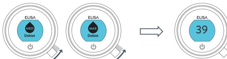
Na het aanpassen van het debiet zal het display na enkele seconden terugkeren naar het temperatuur **Home**-scherm.
