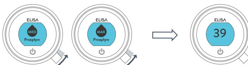
Po wyregulowaniu przepływu wyświetlacz powróci do **ekranu głównego** ze wskazaniem temperatury po kilku sekundach.
