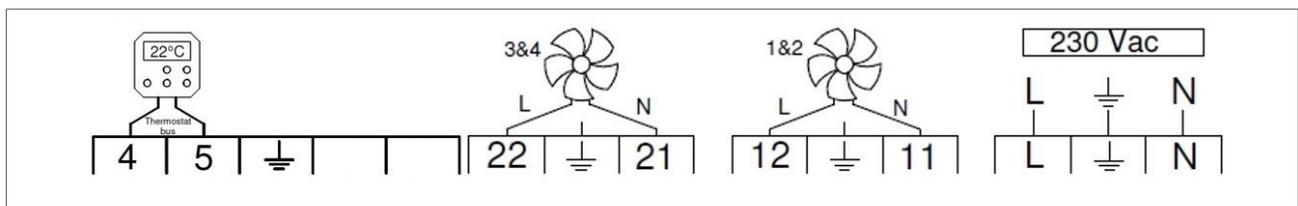
Figure 38 - Principales connexions d'installation XR80+ - XR120+ - AC
