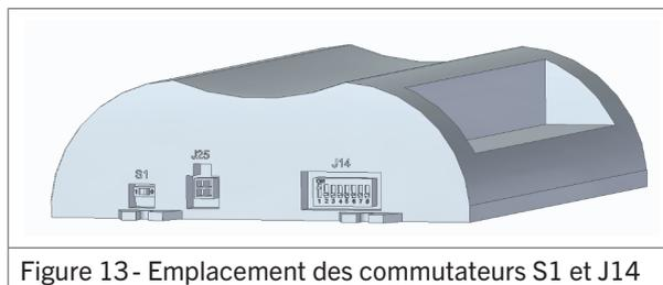
Figure 13 - Emplacement des commutateurs S1 et J14
