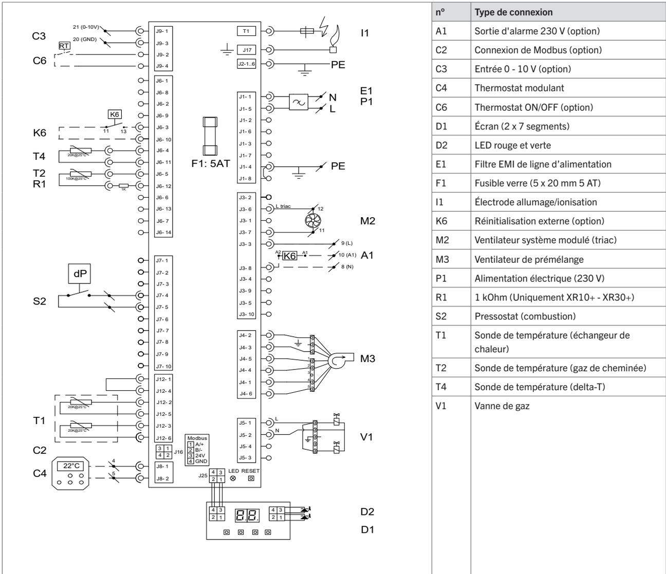
Figure 33 - Schéma de câblage XR10+ - XR60+ - AC
