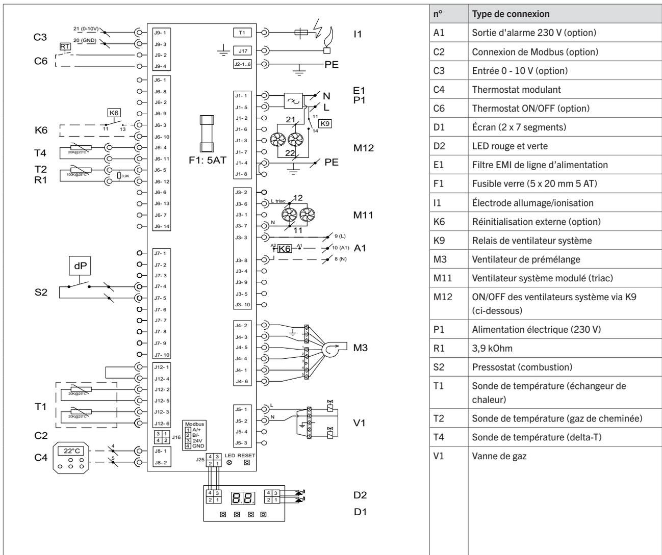
Figure 37 - Schéma de câblage XR80+ - XR120+ - AC
