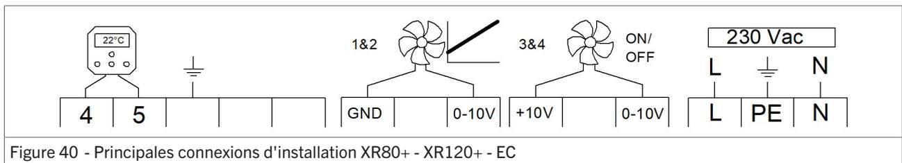
Figure 40 - Principales connexions d'installation XR80+ - XR120+ - EC
