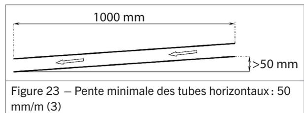
Figure 23 – Pente minimale des tubes horizontaux : 50 mm/m (3)
