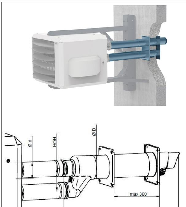
Figure 17 - Terminal horizontal des gaz de cheminée XR+
