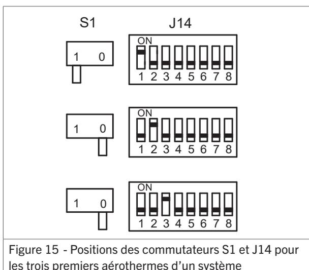
**REMARQUE** Le système ne peut pas fonctionner si le commutateur J14 de plus d'un aérotherme est commuté sur le même numéro.
