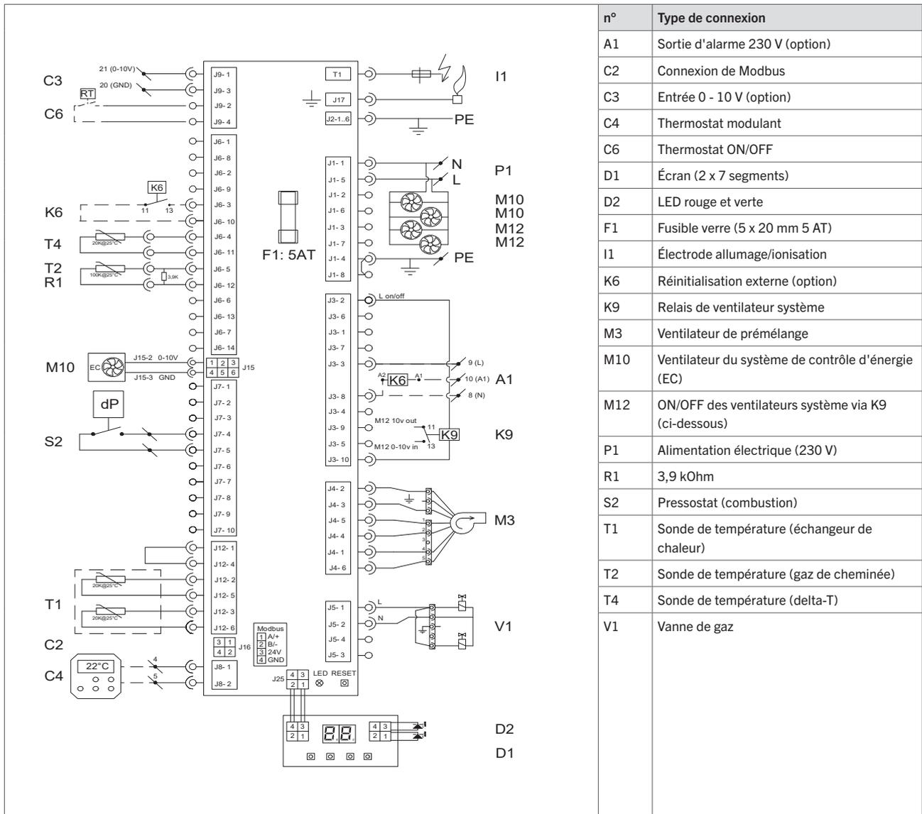
Figure 39 - Schéma de câblage XR80+ - XR120+ - EC
