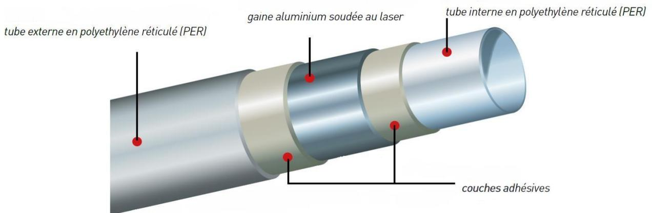
Le tube se compose d'un tuyau extrudé en PE-Rb (réticulation par "silanes"). Sur ce tuyau on colle une couche en aluminium fermée dans le sens de la longueur par une soudure bout à bout au laser. Sur cet ensemble est extrudé après encollage un tuyau en PE-Rb. Selon que le diamètre du tube augmente, l'épaisseur des différentes couches augmente aussi. L'épaisseur de l'aluminium varie de 0,2 à 1,2 mm. Le collage entre le PE-Rb et l'aluminium est réalisé à l'aide d'un adhésif copolymère.
