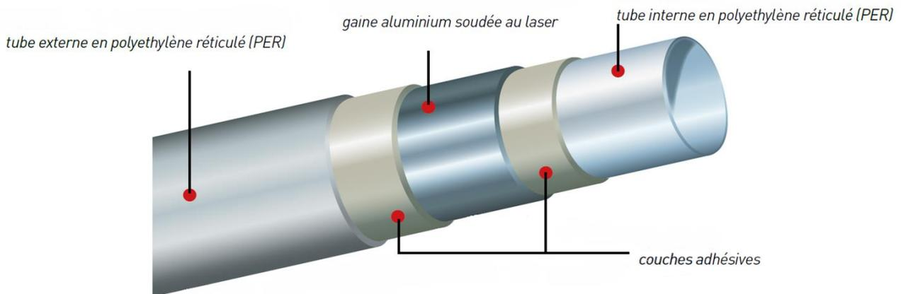
Le tube se compose d'un tuyau extrudé en PE-Rb (réticulation par "silanes"). Sur ce tuyau on colle une couche en aluminium fermée dans le sens de la longueur par une soudure bout à bout au laser.
