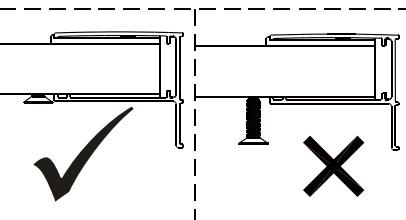
Opmerking: Wanneer u de deur aanpast, moet u alleen de schroef een klein beetje losdraaien.
