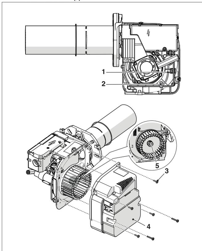
**⚠** Lors de la repose du ventilateur, il est important de respecter la position (B) et de resserrer la vis (5).
