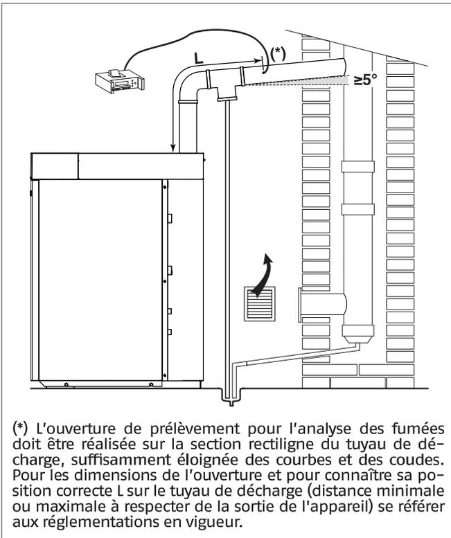
(\*) L'ouverture de prélèvement pour l'analyse des fumées doit être réalisée sur la section rectiligne du tuyau de décharge, suffisamment éloignée des courbes et des coudes. Pour les dimensions de l'ouverture et pour connaître sa position correcte L sur le tuyau de décharge (distance minimale ou maximale à respecter de la sortie de l'appareil) se référer aux réglementations en vigueur.
