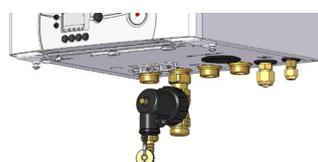
Ce filtre se compose d'un tamis d'une très grande surface de collecte et d'un barreau magnétique afin de retenir tous types de particules se trouvant dans le réseau de chauffage. Il assure également la fonction pot à boues et possède une vanne de vidange afin de chasser les résidus collectés.
