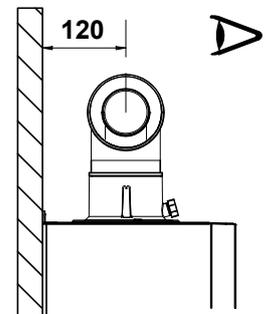
En cas d'évacuation à l'extérieur, le conduit d'évacuation-aspiration doit déborder du mur d'au moins 18 mm pour permettre de positionner la rosace en aluminium et son scellement et éviter ainsi toute infiltration d'eau.
