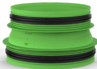
Le raccord avec caoutchouc D180-D200 est utilisé pour faire une connexion rapide et appropriée entre les conduits (extraction et/ou entrée d'air) avec un diamètre intérieur de 180 et 200 mm et pour connecter les conduits D200 à un chauffage externe DucoBox Energy Comfort (Plus) ou à une DucoBox avec connexion D180.
