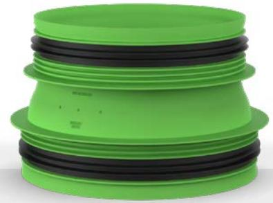
Der Rohrverbinder mit Gummi D160-D180 wird verwendet, um eine schnelle und gute Verbindung zwischen Rohren (Abluft und/oder Zuluft) mit einem Innendurchmesser von 160 und 180 mm herzustellen und Rohre an eine externe Heizung DucoBox Energy Comfort (Plus) (Innendurchmesser 180 mm) oder an eine DucoBox mit Anschluss D160 oder D180 anzuschließen.
