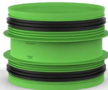
Le raccord avec caoutchouc D160-D160 est utilisé pour faire une connexion rapide et appropriée entre les conduits (extraction et/ou entrée d'air) avec un diamètre intérieur de 160 mm et pour connecter les conduits à une DucoBox avec connexion D160.
