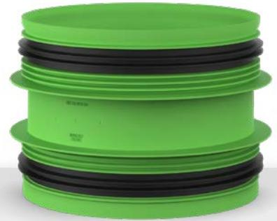
Der Rohrverbinder mit Gummi D160-D160 wird verwendet, um eine schnelle und gute Verbindung zwischen Rohren (Abluft und/oder Zuluft) mit einem Innendurchmesser von 160 mm herzustellen und Rohre an eine DucoBox mit Anschluss D160 anzuschließen.
