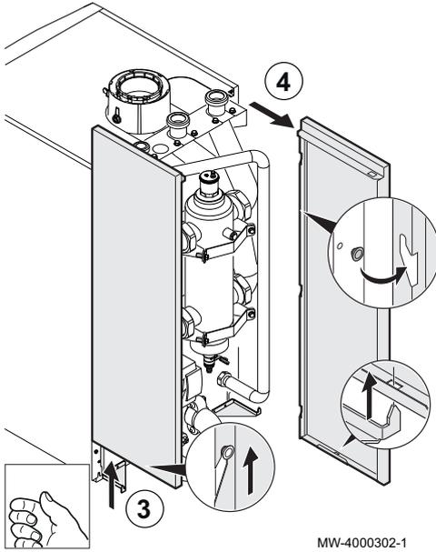
3. Soulever les deux panneaux latéraux du kit de la bouteille de découplage.
