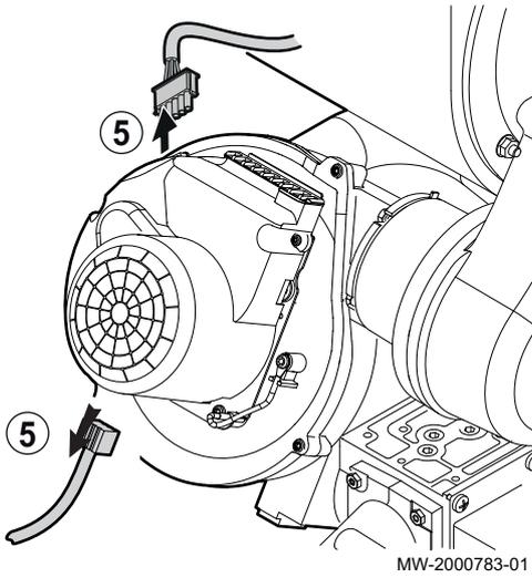
5. Débrancher les câbles d'alimentation et de commande du ventilateur.
