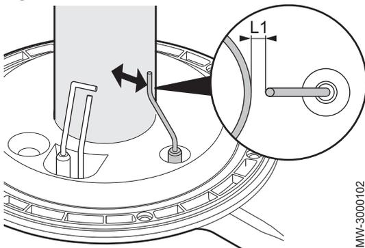
5. Contrôler la distance entre l'électrode de détection de flamme et le brûleur.
