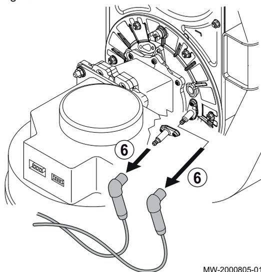
6. Débrancher l'électrode d'allumage et la sonde de détection de la flamme.
