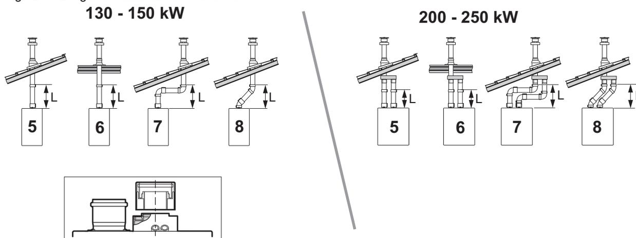
Tab.32 Longueur maximale pour la configuration C<sub>33</sub>
