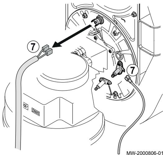
7. Débrancher les 2 fils du thermostat de sécurité de la porte foyer et la cosse sous l'électrode d'allumage.
