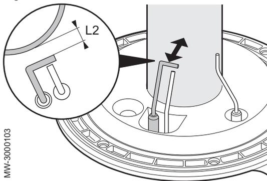
6. Contrôler la distance entre l'électrode d'allumage et le brûleur.
