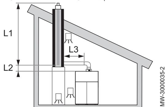
Fig.80 Fumisterie en traversée de toit B<sub>23p</sub>
