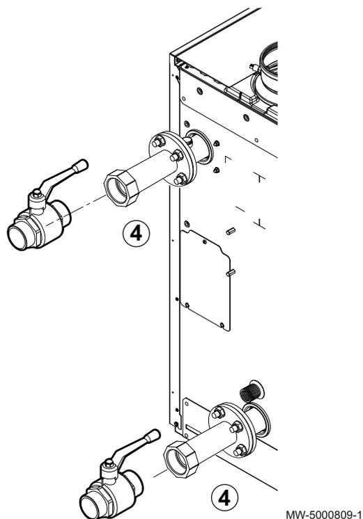
1. Retirer le bouchon antipoussière présent sur l'entrée et la sortie chauffage de la chaudière.
