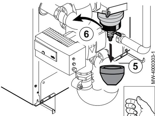
5. Démontez la coque inférieur de l'isolant.
