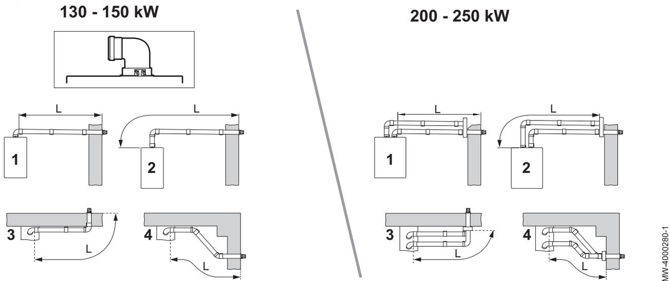
Tab.31 Longueur maximale pour la configuration C<sub>13</sub>
