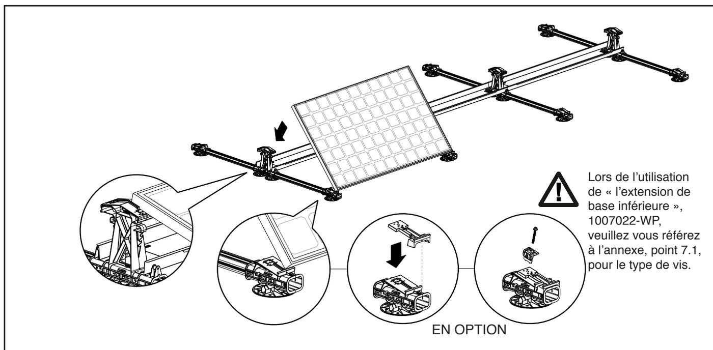
3. Placez les étriers finaux sur le bord du panneau solaire et positionnez-les dans les éléments de base hauts et bas au niveau des trous de montage. Vissez l'étrier final dans le trou de fixation à l'aide de la vis de fixation.
