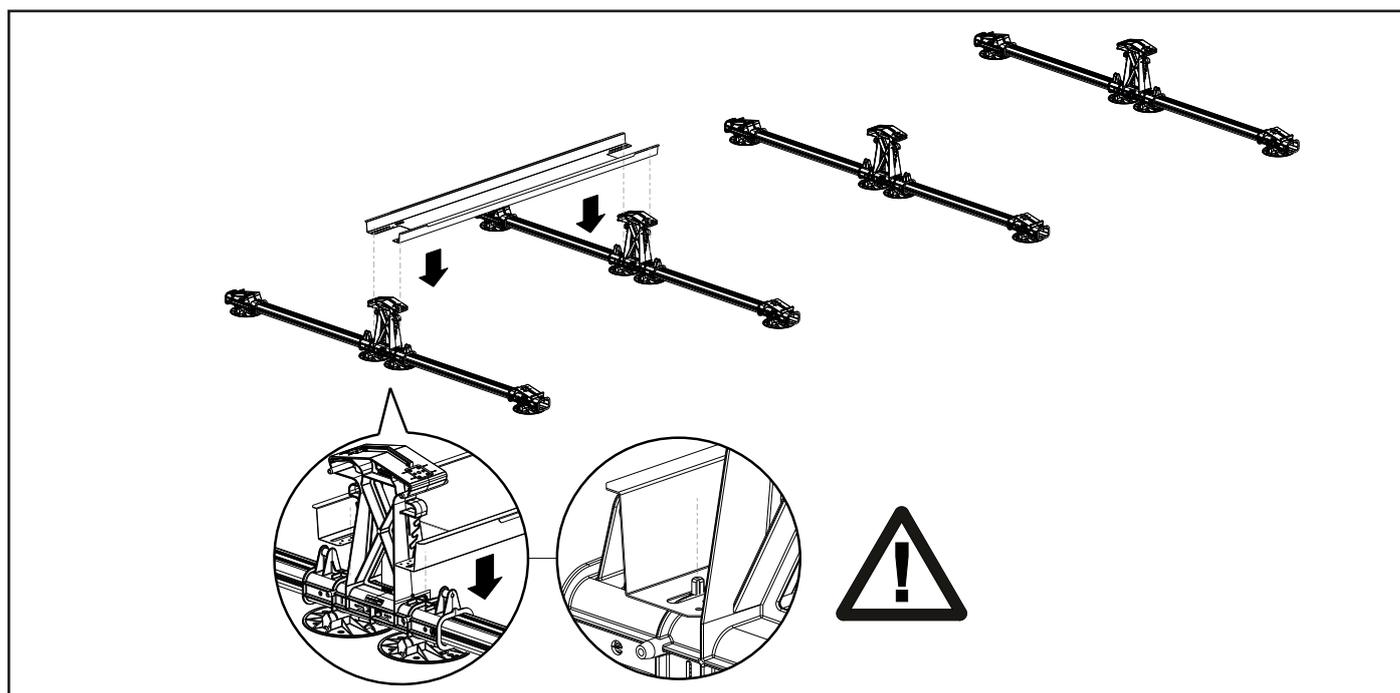
Placez le deuxième bac de lestage entre les segments FlatFix Fusion de manière à ce qu'il chevauche le premier bac de lestage et que les rainures du bac de lestage soient positionnées sur les arêtes verticales de l'élément de base haut.
