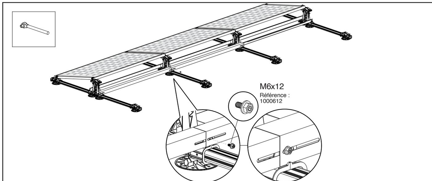
Placez le dernier stabilisateur à l'arrière des panneaux solaires, de manière à ce que le bord inférieur du stabilisateur tombe entre les arêtes verticales des éléments de base hauts et que les rainures des stabilisateurs et les trous de fixation des éléments de base hauts se chevauchent.
