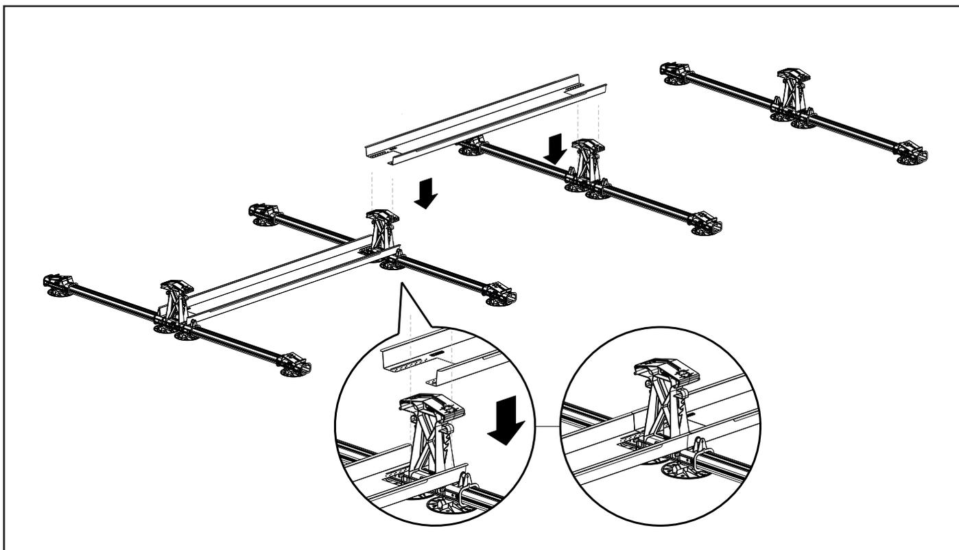
Placez le troisième bac de lestage entre les segments FlatFix Fusion de manière à ce qu'il chevauche le deuxième bac de lestage et que les rainures du bac de lestage soient positionnées sur les arêtes verticales de l'élément de base haut. Répétez ces étapes jusqu'à ce que tous les bacs de lestage soient en place.
