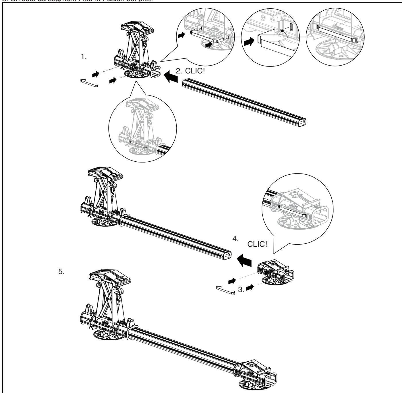
6. Glissez l'extrémité du 2ème profilé de base dans l'ouverture de l'élément de base haut jusqu'à ce qu'il s'enclenche.
