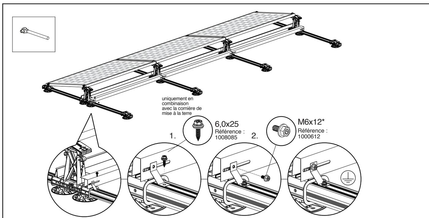
\* Esdec a testé et approuvé la vis métrique M6 x 12 pour fixer le stabilisateur sur l'élément de base haut en plastique. (donc pas de filetage)
