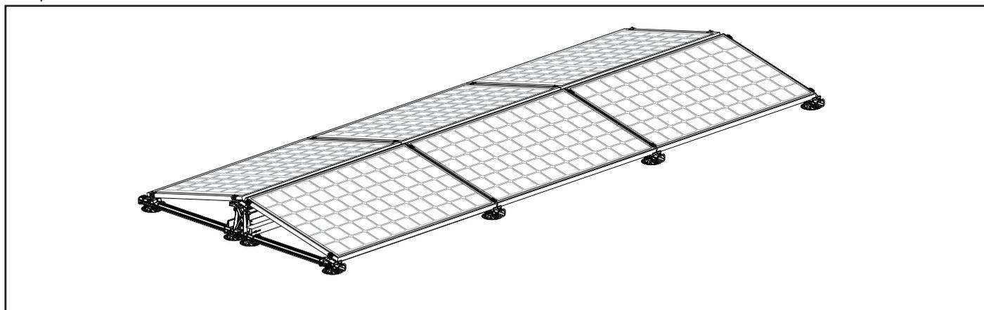
Placez le 2<sup>ème</sup> déflecteur de vent gauche en regard du côté gauche du champ de panneaux et le 2<sup>ème</sup> déflecteur de vent droit en regard du côté droit. **ATTENTION !** La bride du déflecteur de vent doit toujours être tournée vers le champ de panneaux.
