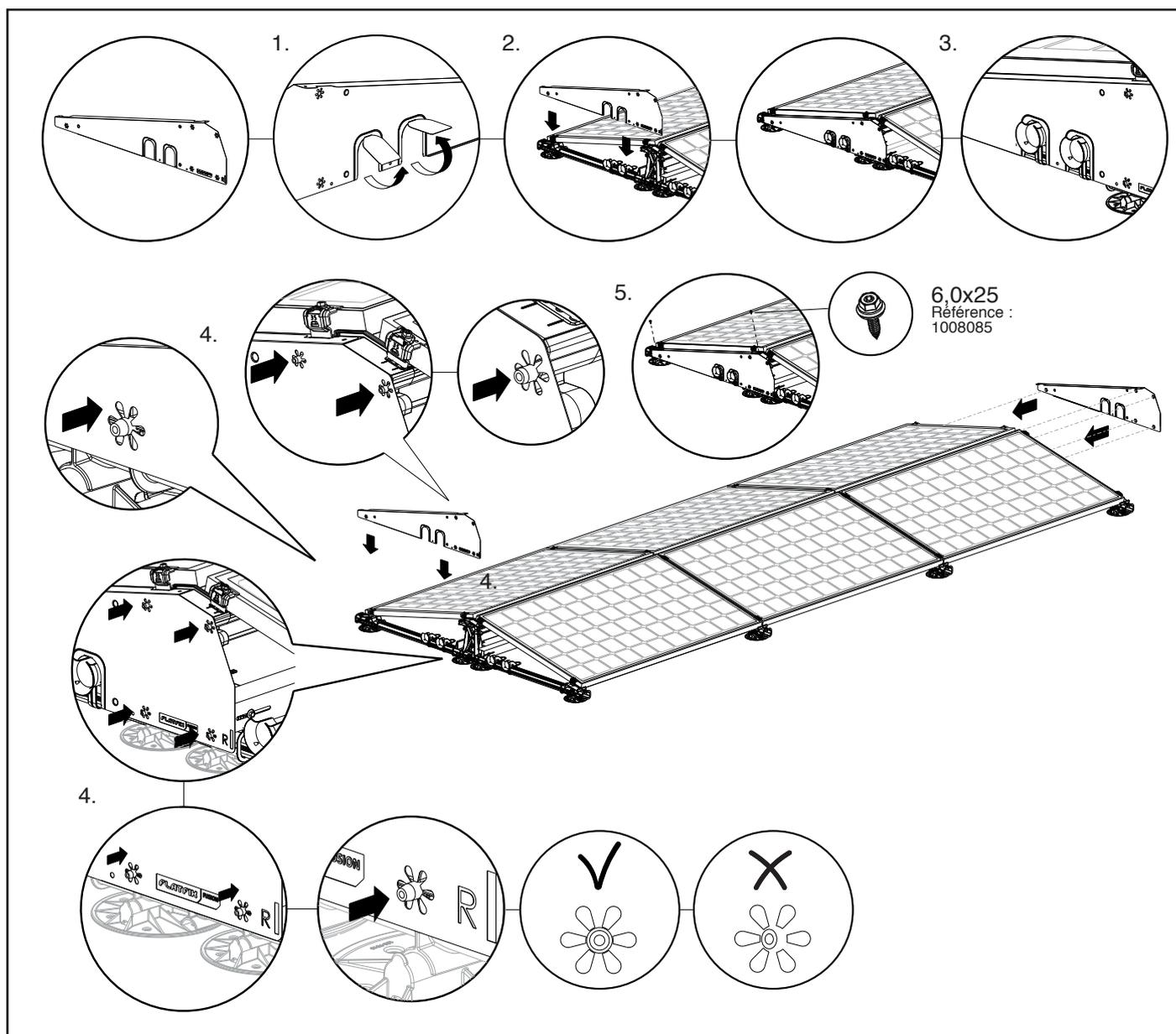
Placez le 2<sup>ème</sup> déflecteur de vent gauche en regard du côté gauche du champ de panneaux et le 2<sup>ème</sup> déflecteur de vent droit en regard du côté droit. **ATTENTION !** La bride du déflecteur de vent doit toujours être tournée vers le champ de panneaux.
