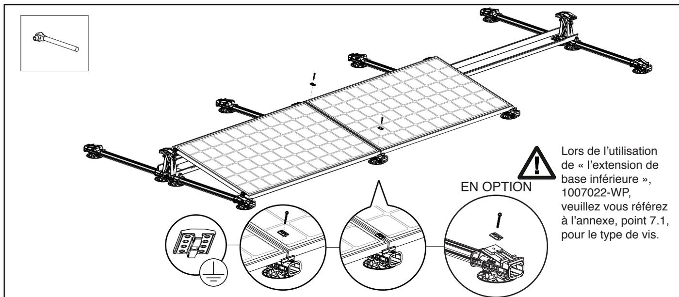
Placez le dernier panneau solaire de la rangée sur les éléments de base, de façon à ce qu'il se trouve entre les arêtes verticales. Vissez ensuite la vis de fixation à l'aide d'un étrier pour module dans les trous de montage des éléments de base. Puis, vissez les deux étriers finaux dans le trou de fixation à l'aide de la vis de fixation. Veillez à ce que les panneaux solaires soient bien droits avant de serrer la vis !
