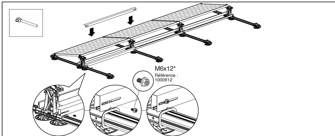
*\*Esdec a testé et approuvé la vis métrique M6 x 12 pour fixer le stabilisateur sur l'élément de base haut en plastique. (donc pas de filetage)*
