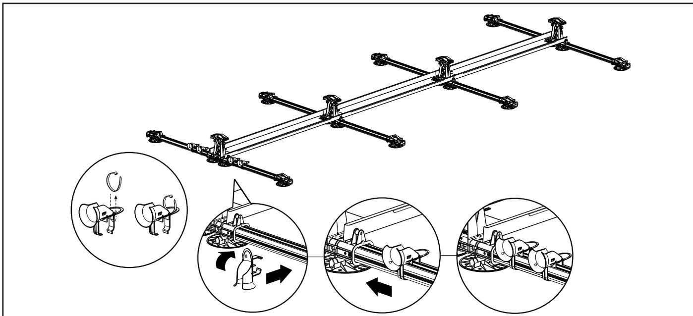
1. Passez tous les câbles (+) dans le 1<sup>er</sup> guide de sortie de câble et tous les câbles (-) dans le 2<sup>ème</sup> guide de sortie de câble. Fixez les câbles dans les guides de sortie de câble au moyen d'attaches de câble pour éviter le déplacement des câbles.
