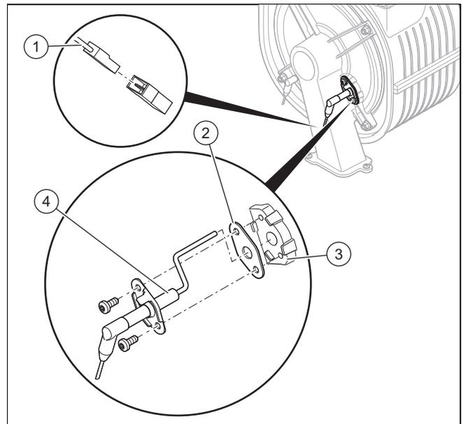
1. Débranchez le connecteur (1) du câble de l'électrode de régulation.
