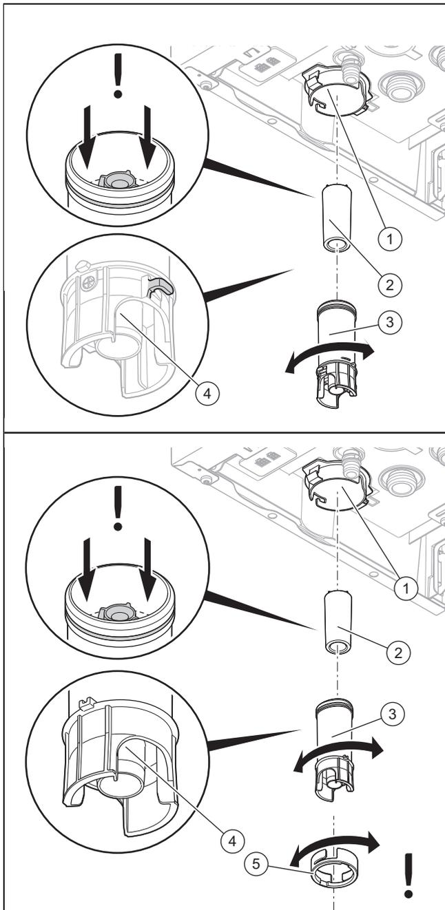
1. Desserrez le circlips (5) si nécessaire.
