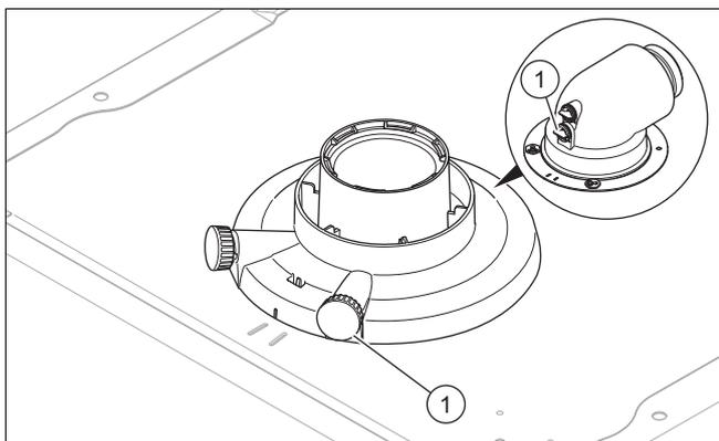
6. Mesurez la teneur en CO<sub>2</sub> au point de mesure (1) des gaz de combustion et notez la valeur mesurée dans le compte-rendu.
