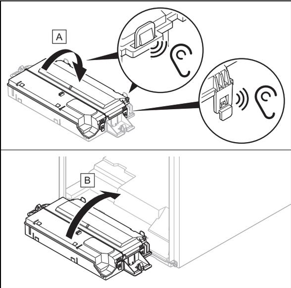
1. Vérifiez que les supports des côtés droit et gauche du boîtier électrique sont bien montés.
