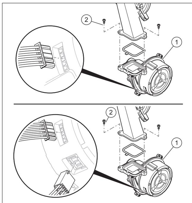
2. Débranchez le connecteur mâle ou les deux connecteurs mâles du moteur du ventilateur.
