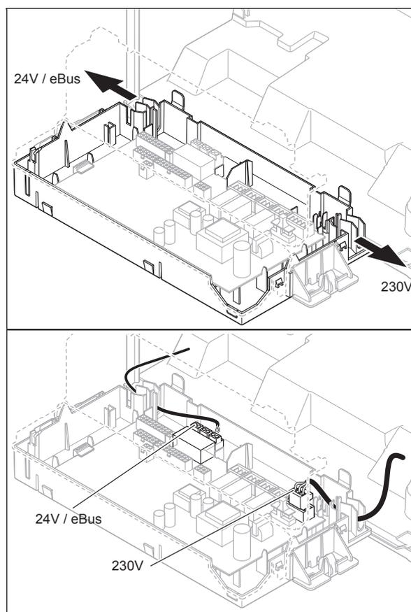
Faites passer les câbles de raccordement des composants à connecter dans le passe-câbles situé en bas du produit, à gauche.
