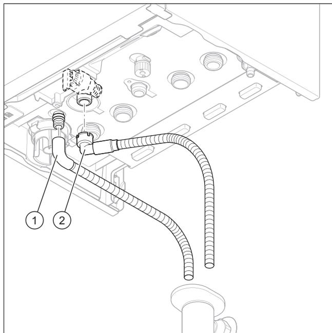
1. Placez les tuyaux d'évacuation fournis pour effectuer les raccordements de sorte qu'ils ne gênent pas le retrait et la mise en place de la partie inférieure du siphon.
