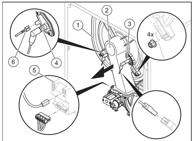
5. Débranchez le câble de mise à la terre (6) de l'électrode d'allumage (4), les deux connecteurs du transformateur d'allumage (5) et le connecteur du câble de régulation (3).
