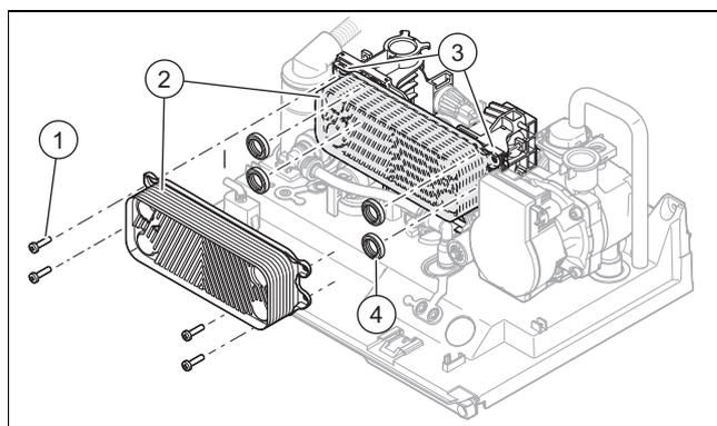
1. Dévissez les quatre vis (1) de l'échangeur à plaques sanitaire.
