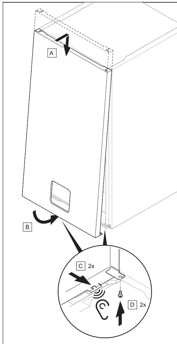
2. Serrez les deux vis situées en bas du produit, à gauche et à droite.
