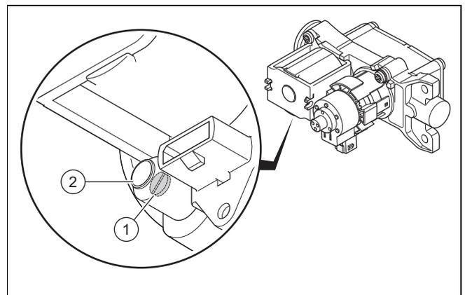
3. Desserrez la vis de contrôle (1).
