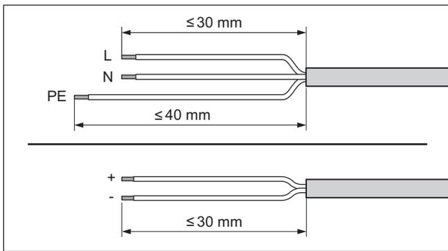
6. Dénudez les câbles souples comme indiqué dans l'illustration. Faites attention à ne pas endommager les isolations des différents fils électriques.
