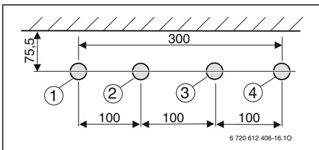
Fig. 16 Mesures pour l'installation des raccordements à charge du client
