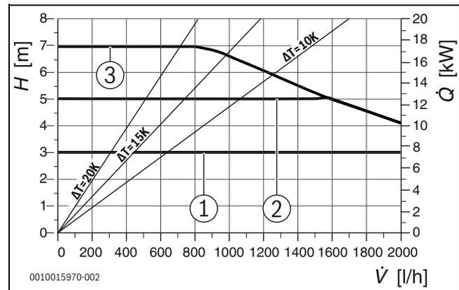
Fig. 7 Courbes caractéristiques de pompe pression différentielle constante
