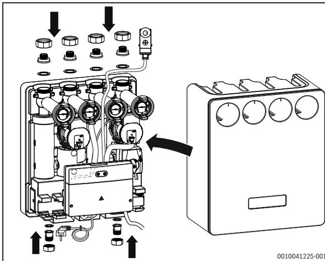
Fig. 15 Montage de l'isolation thermique
