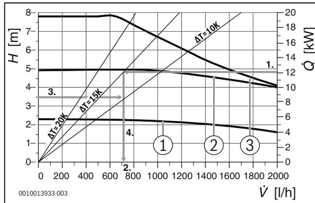
Fig. 5 Courbes caractéristiques de pompe à vitesse de rotation constante
