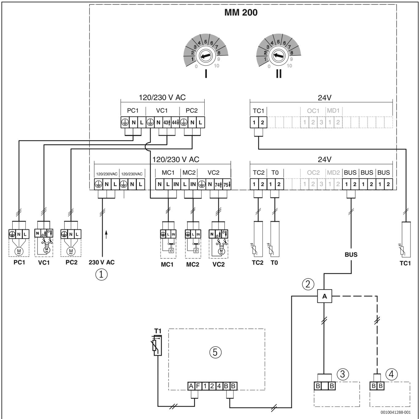
Fig. 22 Schéma de connexion HSM2-M 20/7 MM200
