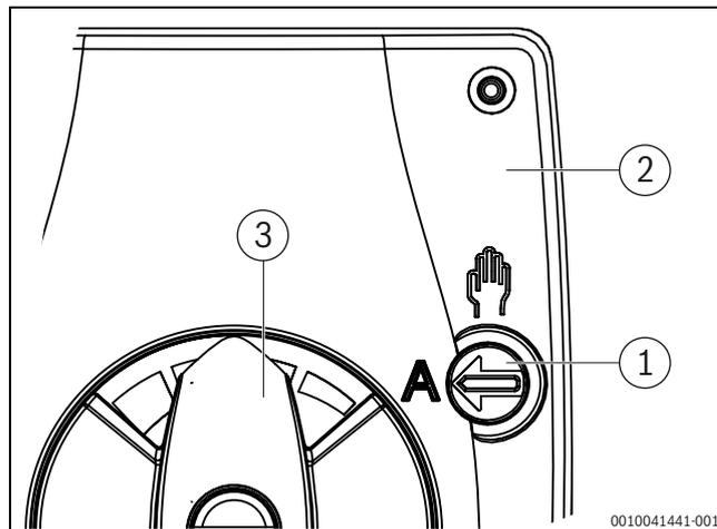
Fig. 30 Servomoteur de vanne mélangeuse
