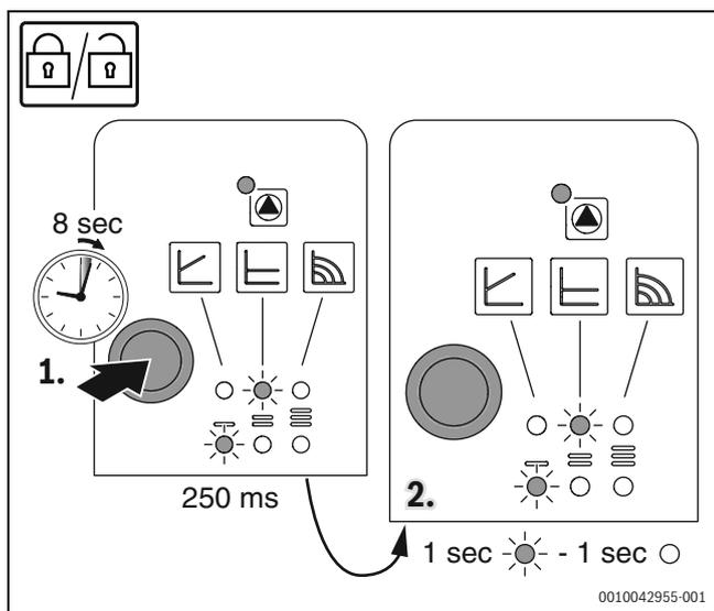
Fig. 29 Réglage de la pompe, verrouiller/déverrouiller la touche
