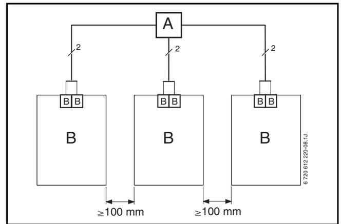
Fig. 20 Raccordement des câbles de BUS via une boîte de dérivation (A)
