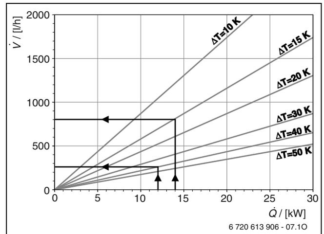
Fig. 4 Débit - puissance calorifique
