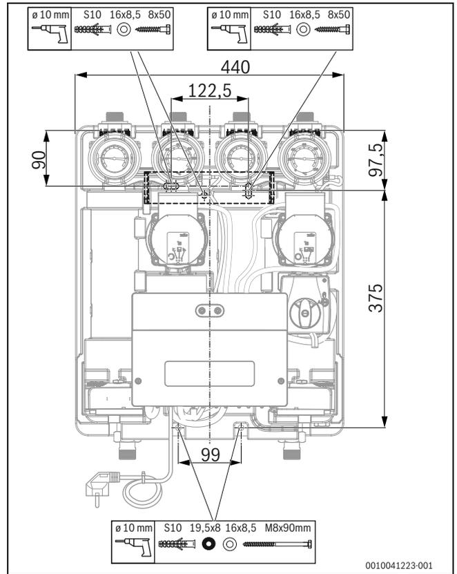
Fig. 14 Fixation sur le mur selon l'exemple HSM2-M 20/7 MM200
