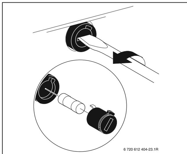
Fig. 31 Remplacer le fusible
