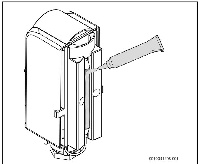
Fig. 17 Appliquer la pâte thermoconductrice
