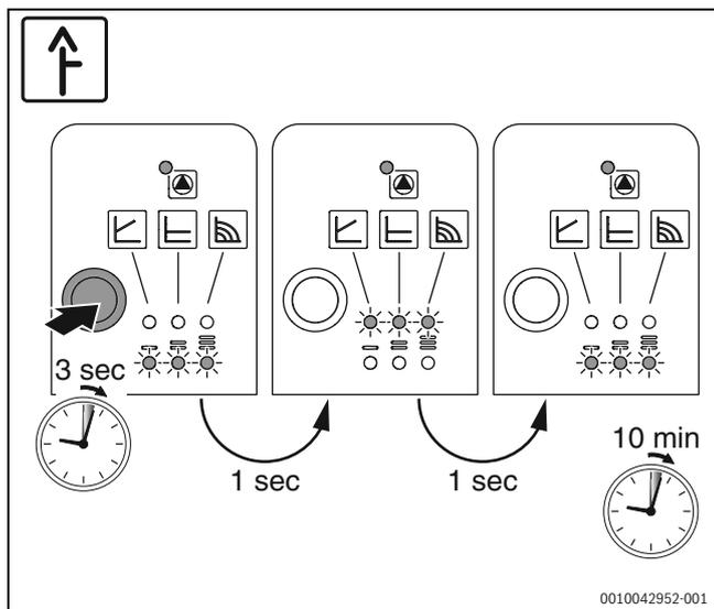
Fig. 27 Réglage de la pompe, purge
