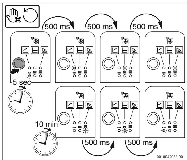
Fig. 28 Réglage de la pompe, redémarrage manuel
