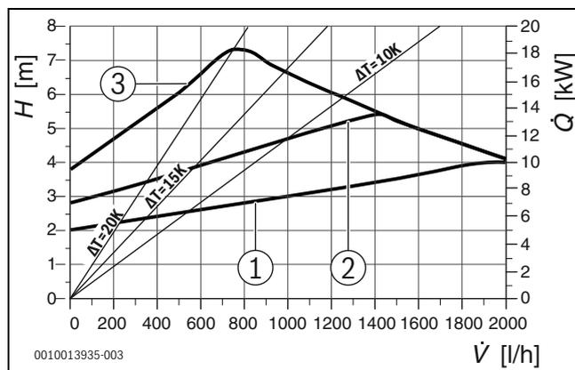
Fig. 6 Courbes caractéristiques de pompe pression différentielle variable
