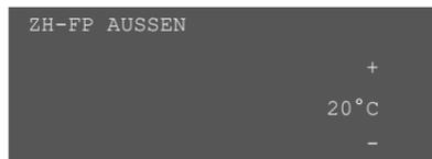
1) Der Fußpunkt ist die gewünschte Vorlauftemperatur bei einer maximalen Außentemperatur (meist +20 °C). Bei einer Außentemperatur, die höher als der eingestellte Fußpunkt ist, geht das Gerät nicht in Betrieb.
