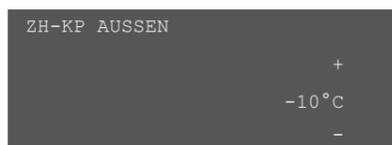
2) Der Klimapunkt ist die gewünschte Vorlauftemperatur bei einer minimalen Außentemperatur (meist -10 °C). Bei einer Außentemperatur, die niedriger ist als der eingestellte Klimapunkt, bleibt die ZH- Vorlauftemperatur auf dem eingestellten Wert.
