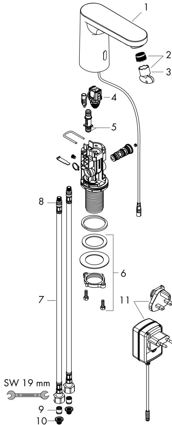
**Vernis Blend****Mitigeur de lavabo électronique avec pré-réglage de la température sur secteur**Surfaces: **chromé** Numéro d'article: **71501000**
