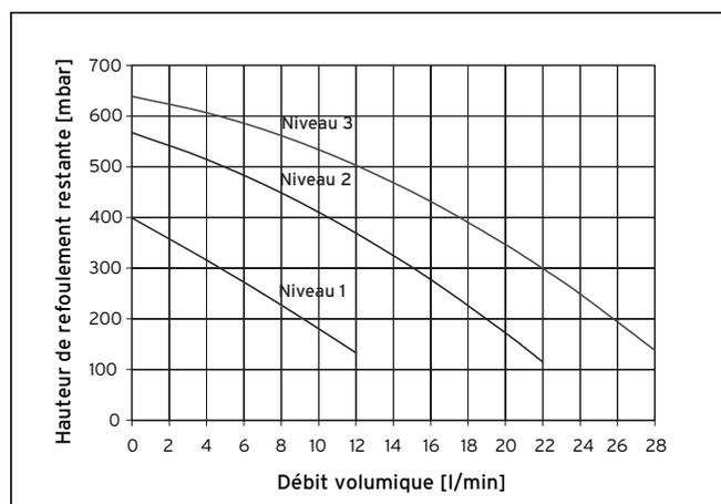
Fig. 5.1 Hauteur de refoulement du poste solaire 22 l/min
