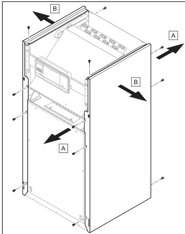
2. Dévissez les 4 vis situées à l'avant et les 3 vis situées à l'arrière pour démonter un des habillages latéraux.
