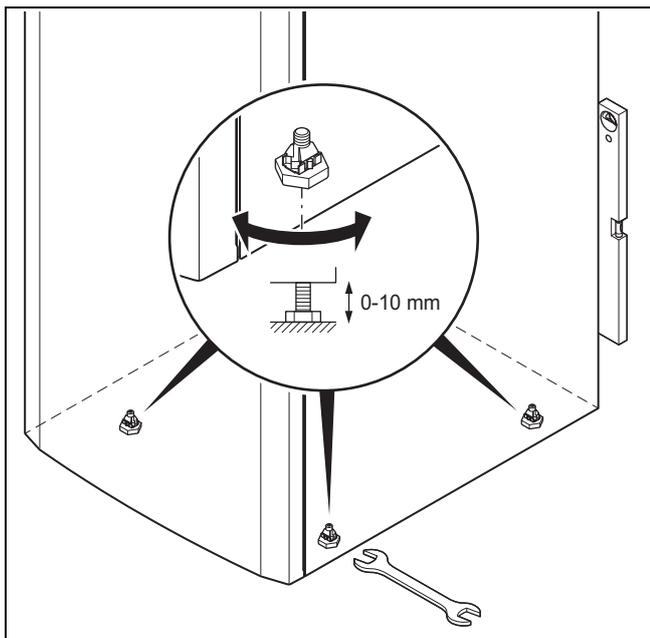
► Ajustez les pieds de réglage de façon à mettre le produit parfaitement de niveau.
