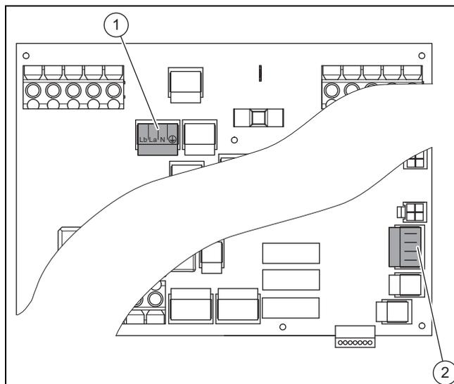
Pour raccorder un relais de coupure pour la pompe de forage externe, vous pouvez vous servir du contact inverseur X143 (1) avec affectations Lb, La, N et PE.
