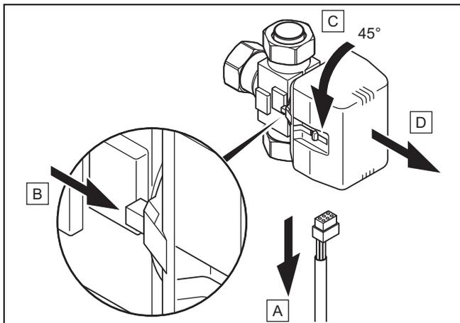
14. Débranchez le câble d'alimentation électrique au niveau de la tête du moteur de la vanne (A).
