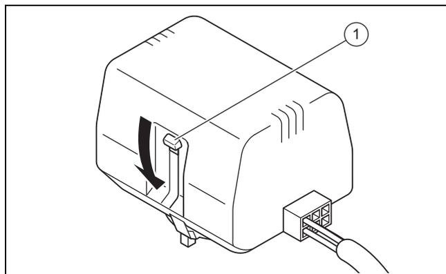
3. Appuyez sur le levier d'inversion blanc (1) au niveau de la tête du moteur de la vanne de façon qu'il s'enclenche en position intermédiaire. La vanne de chauffage/de charge du ballon bascule alors en position intermédiaire.
