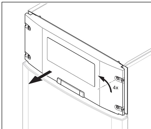
2. Tournez les quatre vis d'un quart de tour et tirez la protection du tableau de commande vers l'avant.
