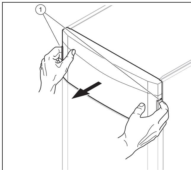
1. Démontez le clapet avant du tableau de commande. Pour cela, mettez les deux mains dans les poignées encastrées, puis tirez le clapet avant vers l'avant.
