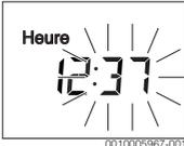
Le CR 50 est maintenant réglé comme régulateur et l'écran bascule vers l'affichage standard. L'installation de chauffage et la production d'eau chaude sanitaire fonctionnent (eau chaude sanitaire en continu, chauffage en fonction du programme horaire).
