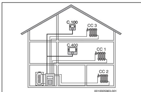
Fig. 2 Exemple d'installation de chauffage avec trois circuits de chauffage et CR 100 comme commande à distance (maison individuelle avec logement annexe ou atelier)
