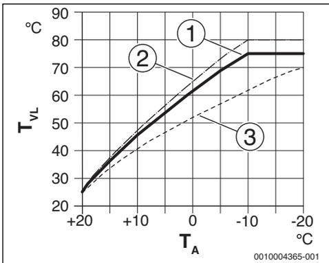
Fig. 13 Réglage de la courbe de chauffage pour radiateur pente ascendante au-dessus de la température de détermination  $T_{AL}$  et température extérieure minimale  $T_{A,min}$
