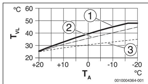
Fig. 11 Réglage de la courbe de chauffage pour chauffage au sol
