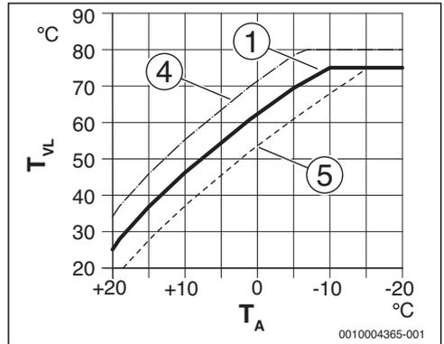
Fig. 14 Réglage de la courbe de chauffage pour radiateur
