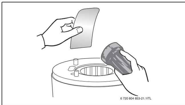
Fig. 59 Contrôler la présence de résidus dans le corps de chauffe
