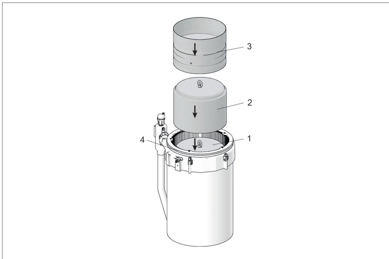
**Illustration 6.9 Assembler la chambre de combustion**
