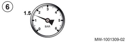
6. Den Druck in der Anlage kontrollieren. Wenn der Wasserdruck unter 1,5 bar liegt, Wasser nachfüllen.
