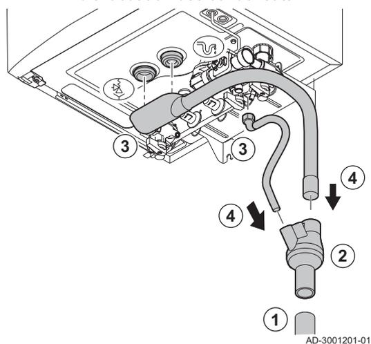
1. Monter un conduit d'évacuation en plastique de 32 mm de diamètre minimum, qui se termine dans une bouche d'évacuation.
