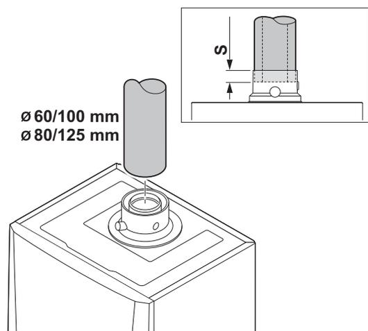
**S** Profondeur d'insertion 30 mm
