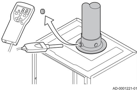
1. Dévisser le bouchon de la prise de mesure des fumées.
