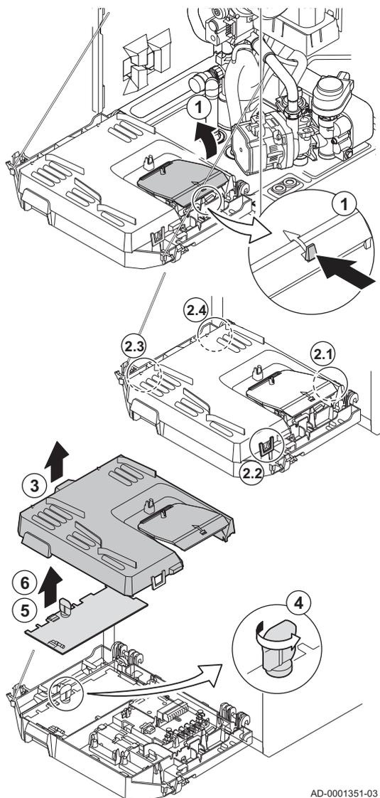
Si, dans le coffret tableau de commande, une carte électronique de commande défectueuse doit être remplacée, procéder comme suit :
