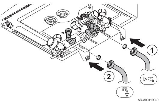
1. Raccorder la conduite d'arrivée d'eau froide au raccord d'entrée d'eau froide sanitaire
