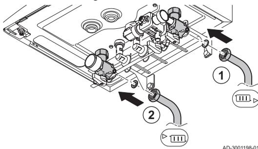
1. Raccorder le conduit d'entrée de l'eau du chauffage central au raccord de retour du chauffage central
