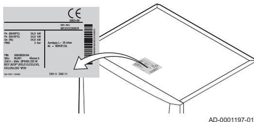
La plaquette signalétique située sur le haut de la chaudière mentionne le numéro de série de la chaudière et ses caractéristiques importantes telles que le modèle et la catégorie. Les numéros de configuration CN1 et CN2 figurent également sur la plaquette signalétique.
