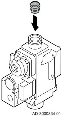
1. Gasblende in der Gasventileinheit montieren (siehe ggf. Tabelle). Wenn der Kessel für G31 (Propan) modifiziert ist:
