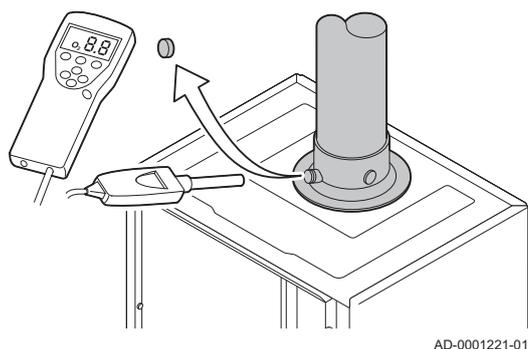
1. Die Kappe von der Prüföffnung für Abgas entfernen.
