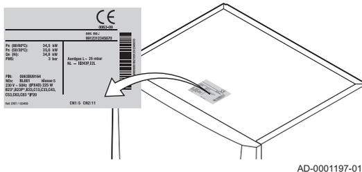
Auf dem Typenschild oben am Heizkessel sind die Seriennummer und wichtige technische Daten des Heizkessels, wie Ausführung und Gaskategorie, angegeben. Die Konfigurationscodes CN1 und CN2 sind ebenfalls auf dem Typenschild angegeben.
