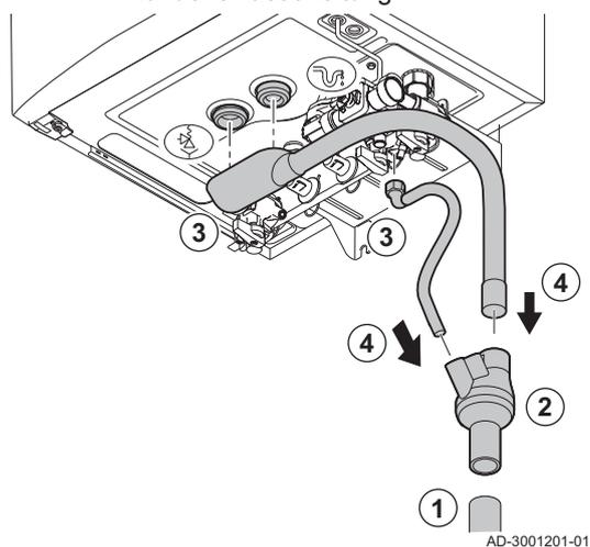
1. Einen Kunststoffablaufschlauch mit der Mindestgröße  $\varnothing$  32 mm am Ablauf anbringen.
