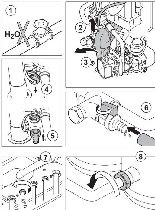
Die Warmwasserspeicher austauschen, wenn sie defekt sind. Hierzu wie folgt vorgehen:
