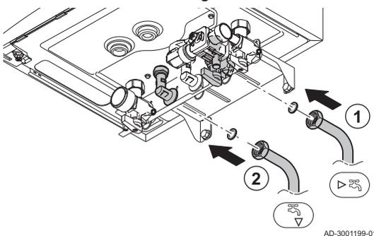
1. Den Kaltwasserzulauf am Kaltwasseranschluss anschließen .
