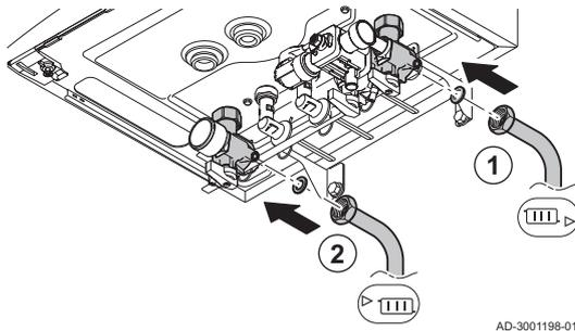
1. Die Rücklaufleitung für Heizungswasser am Heizungsrücklauf anbringen.
