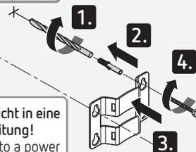
**Vorsicht! Bohren Sie nicht in eine Strom- oder Wasserleitung!**
