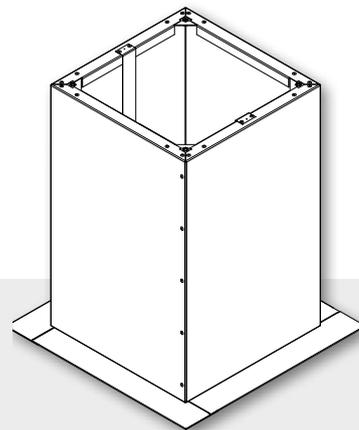
Socle de toiture insonorisant pour l'installation rapide et facile du Duco RoofFan sur toits plats.
