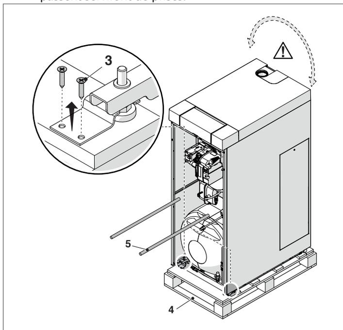
**⚠** Faire attention à l'oscillation de la chaudière pendant le levage. Sur le sol plat et lisse et pour les **petits** déplacements, le groupe thermique peut être soulevé **légèrement** et déplacé avec les roues (6).
