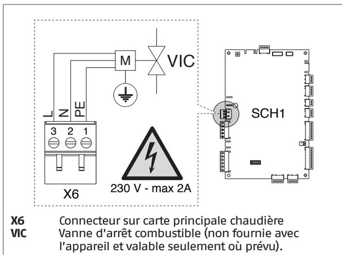
**⚠** Vérifier qu'au paramètre 2030 la valeur 1 (par défaut) soit programmée. Si le temps de post-ventilation du brûleur est modifié, il est nécessaire de programmer au paramètre 2079 une valeur (en secondes)  $\geq$  à celle à peine programmée sur le brûleur.
