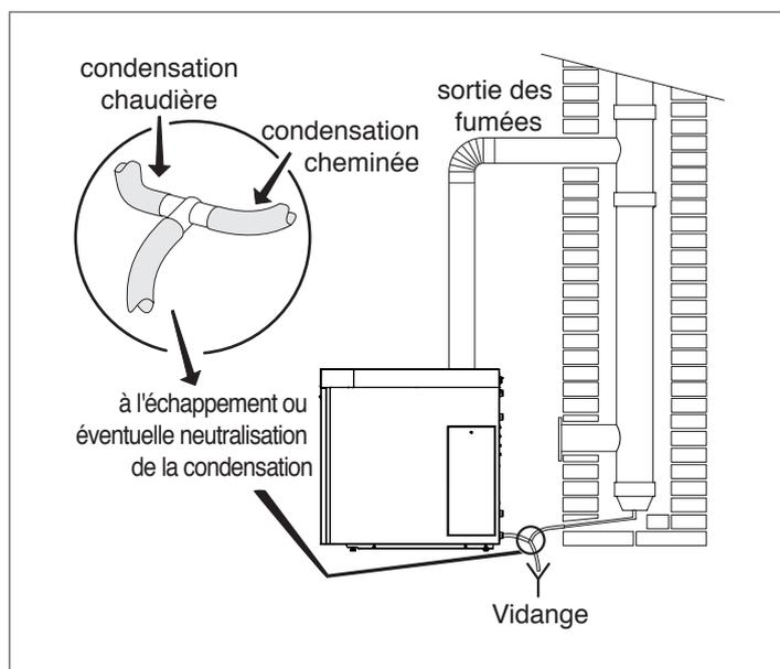
**⚠** Tout dispositif éventuel destiné à la neutralisation du condensat pourra être relié après le siphon. Pour le calcul de la durée de la charge de neutralisation, il faut que soit évalué l'état de consommation du dispositif de neutralisation après une année de fonctionnement. Sur la base de cette information, il sera possible d'extrapoler la durée totale de la charge.
