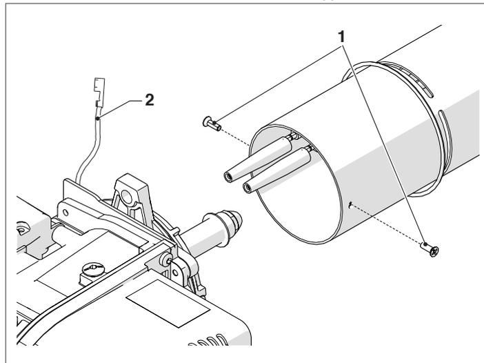
**⚠** Une fois le gueulard démonté, vérifier son bord avant qui doit avoir un profil régulier sans incrustations, brûlures ni déformations.
