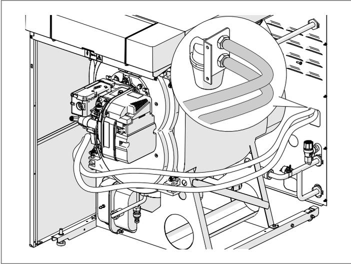
La connexion à l'aspiration de la pompe du fioul doit être effectuée directement sur le filtre (1) (accessoire), le tuyau de retour doit être relié sur le raccord prévu à cet effet (2).
