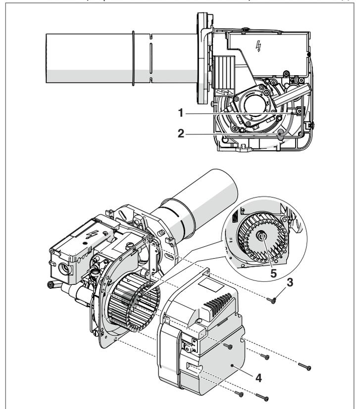
**⚠** Lors de la repose du ventilateur, il est important de respecter la position (B) et de resserrer la vis (5).
