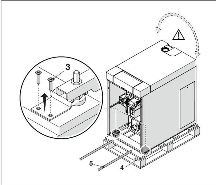
**⚠** Faire attention à l'oscillation de la chaudière pendant le levage. Sur le sol plat et lisse et pour les **petits** déplacements, le groupe thermique peut être soulevé **légèrement** et déplacé avec les roues (6).
