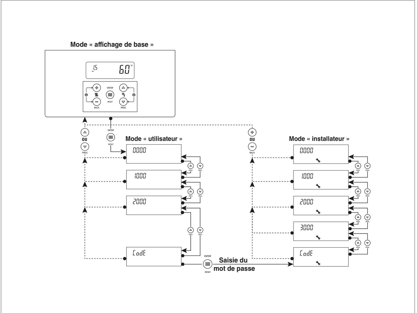
Exemple de programmation d'un paramètre
