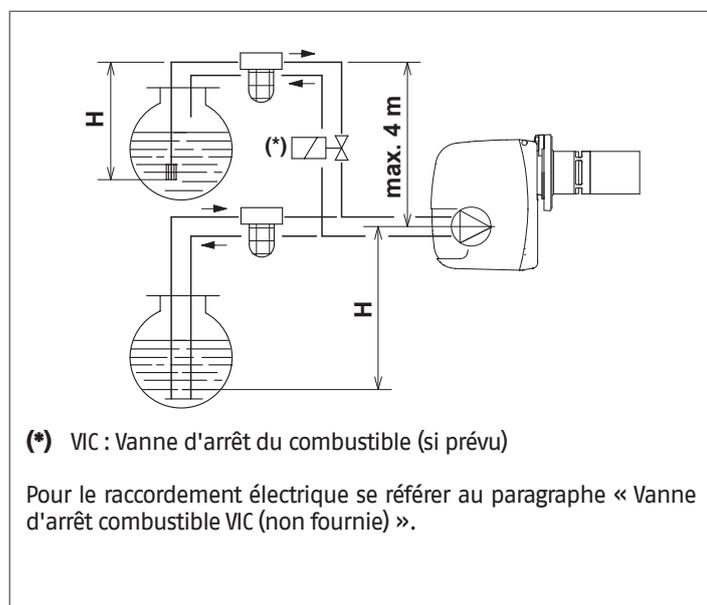
**⚠** Si l'installation d'une vanne d'arrêt du combustible (VIC) est prévue dans le circuit d'alimentation en carburant du fioul du brûleur, la fermeture de la soupape doit être retardée pour éviter que la section de tuyau entre la pompe et la vanne se mette en dépression (vide).
