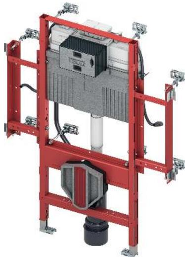
TECEprofil WC-Gerontomodul mit Uni-Spülkasten, Keramikbefestigung für 48 cm Sitzhöhe gemäß DIN 18040-1, Bauhöhe 1120 mm
