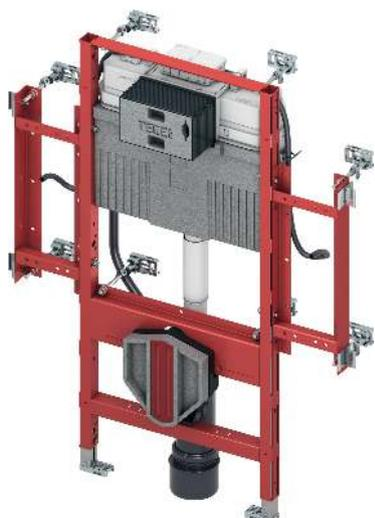
**Module WC Gérantomodule TECEprofil avec réservoir Uni, fixation de la cuvette pour une hauteur d'assise de 48 cm selon DIN 18040-1, hauteur 1120 mm**
