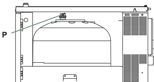
fig. 29 - Purgeur automatique du module hydraulique
