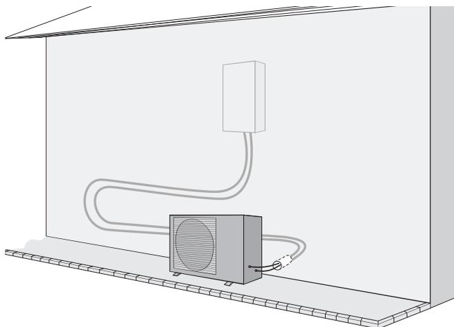
*fig. 12 - Exemple conseillé de disposition des liaisons frigorifiques*
