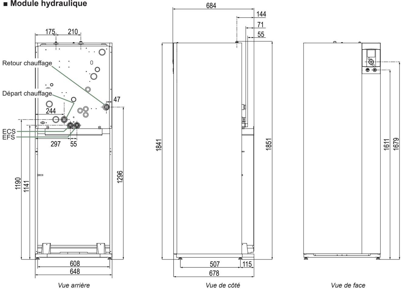
Encombrement du module hydraulique, voir fig. 15, page 20.
