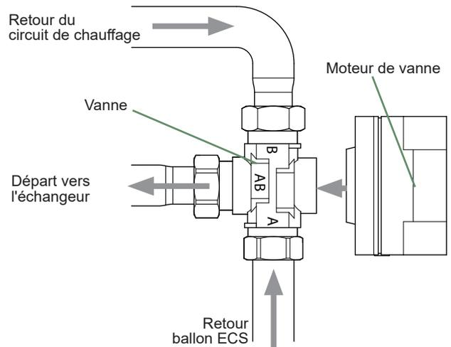
fig. 56 - Montage de la vanne directionnelle
