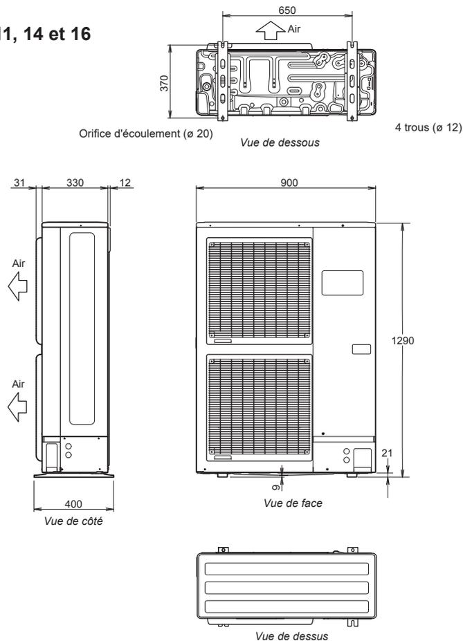
fig. 1 - Dimensions en mm
