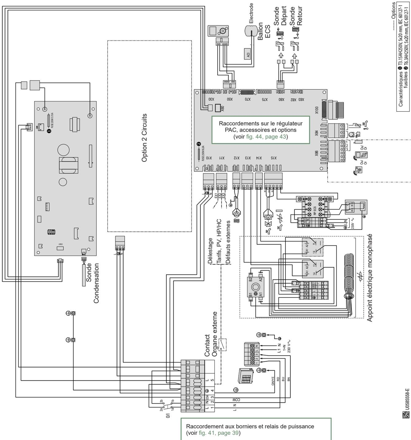
fig. 53 - Câblage électrique module hydraulique Alfa Excelsia Duo A.I. monophasée (hors raccordements installateur)
