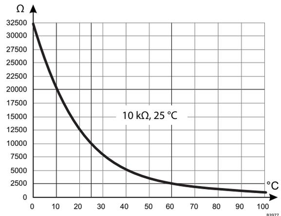
fig. 6 - Valeur ohmique des sondes (Module hydraulique)
