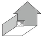
Le module placé dans un coin: + 6 dB(A)
