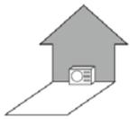
Le module placé contre un mur: + 3 dB(A)
