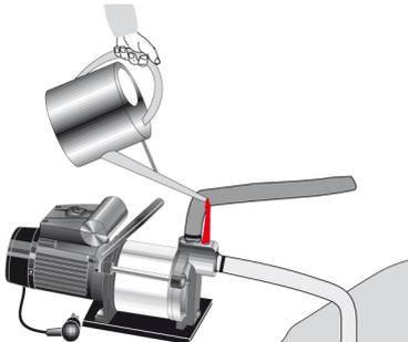
3. Einfüllschraube mit maximal 10 Nm einschrauben.
