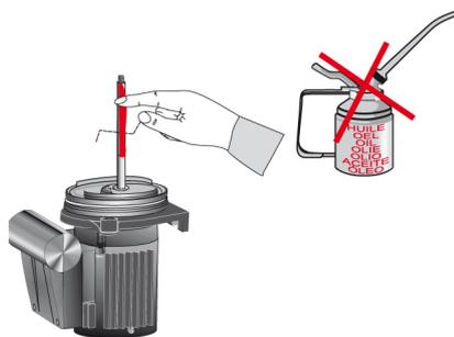
11. Rotierenden Teil der Gleitringdichtung 433 aufschieben.
