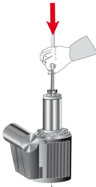
6. Feststehenden Teil der Gleitringdichtung 433 montieren und auf korrekten Sitz achten.
