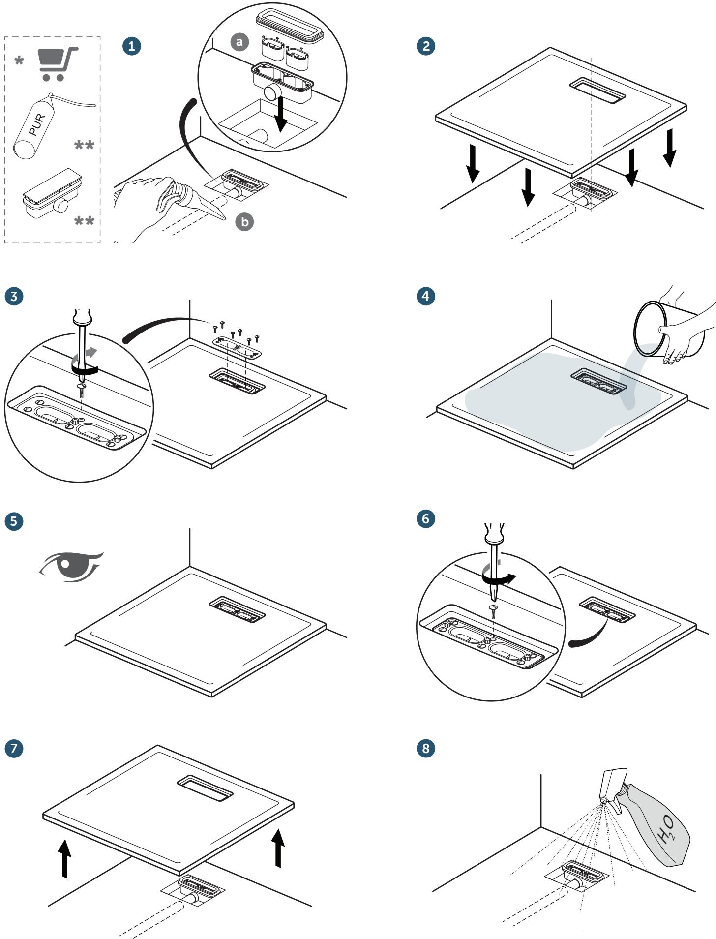
**9** Sopra pavimento, On floor, Sur sol, Über dem Fußboden, Sobre el suelo, Boven de vloer, Επάνω στο δάπεδο, На полу, Nad podlahou, Nad podlahou, Na podłodze, Na tla, Na pod, Инсталация на пода.
