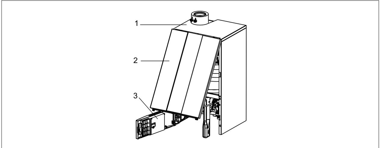
**Abb. 6.13** Gerätedeckel und Frontverkleidung montieren
