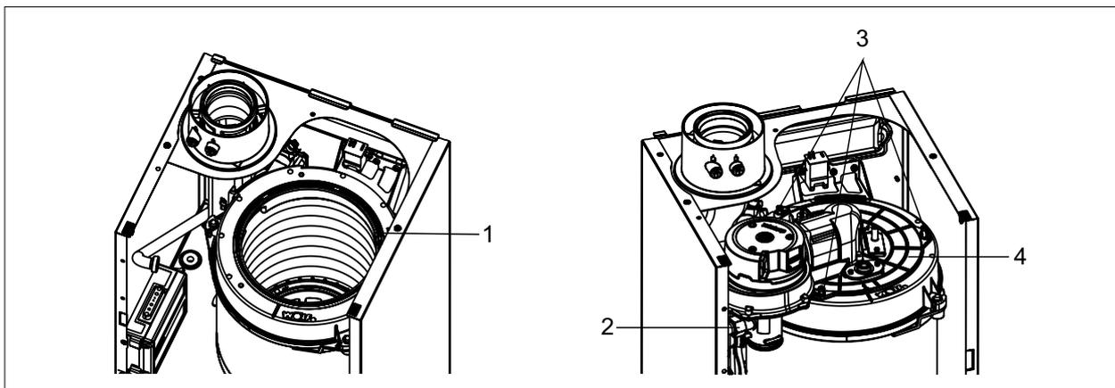
Abb. 6.11 Brennkammerdeckel montieren
