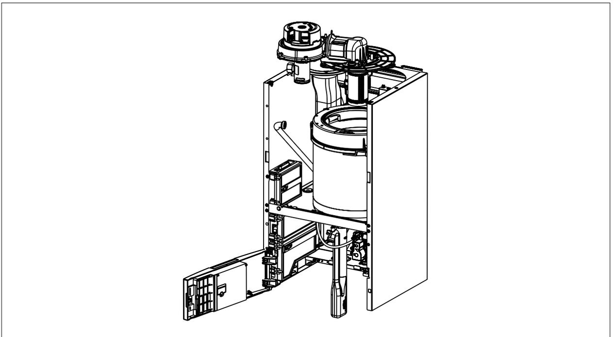
**Abb. 5.9** Brennkammerdeckel abheben
