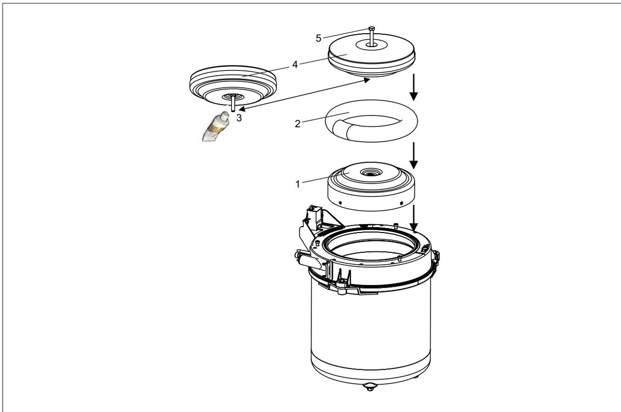
Abb. 6.10 Brennkammer zusammenbauen
