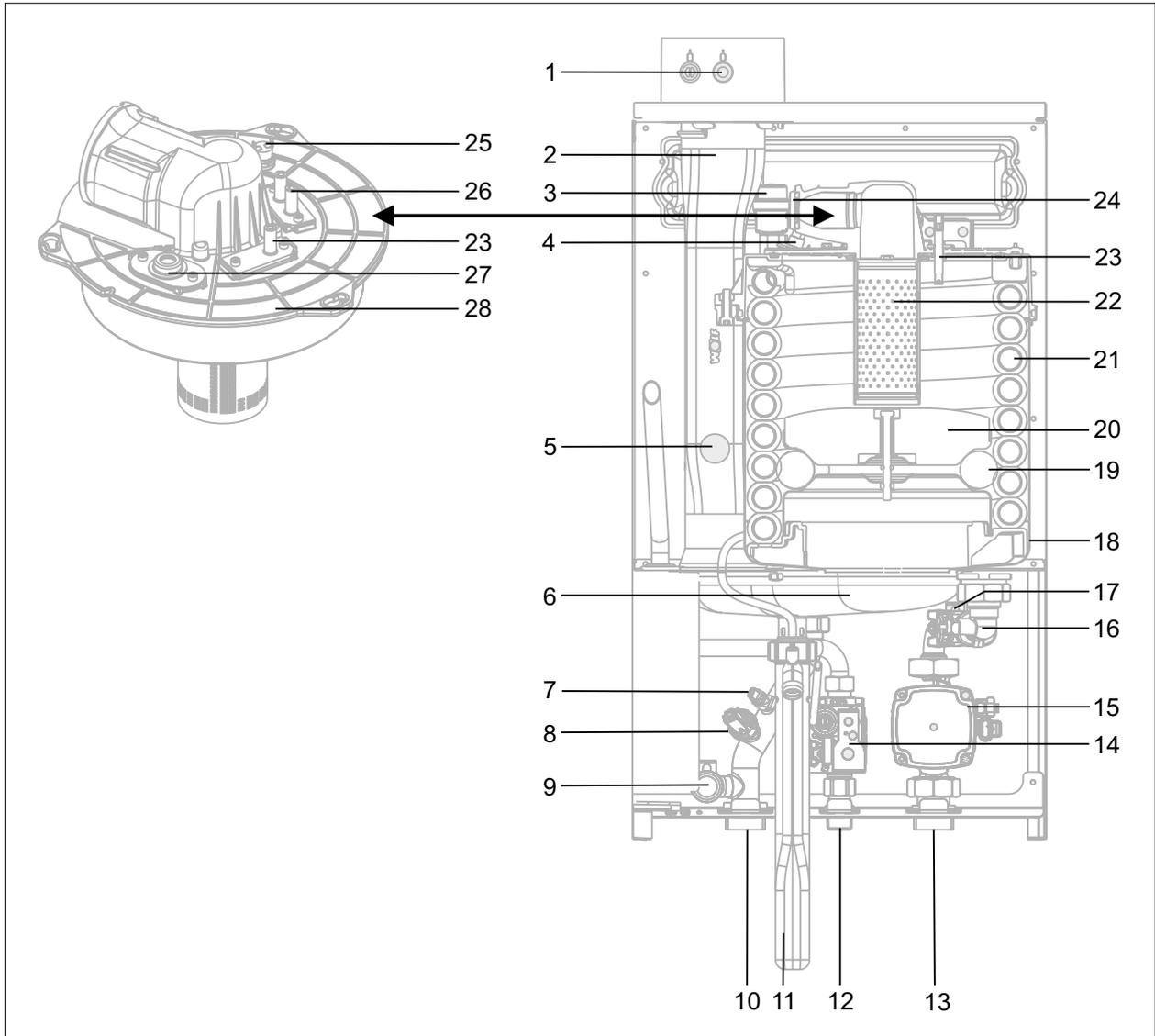
**Abb. 4.1 Aufbauschema Gasbrennwerttherme**
