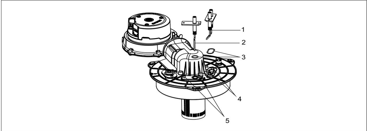
**Abb. 6.3 Elektroden austauschen**
