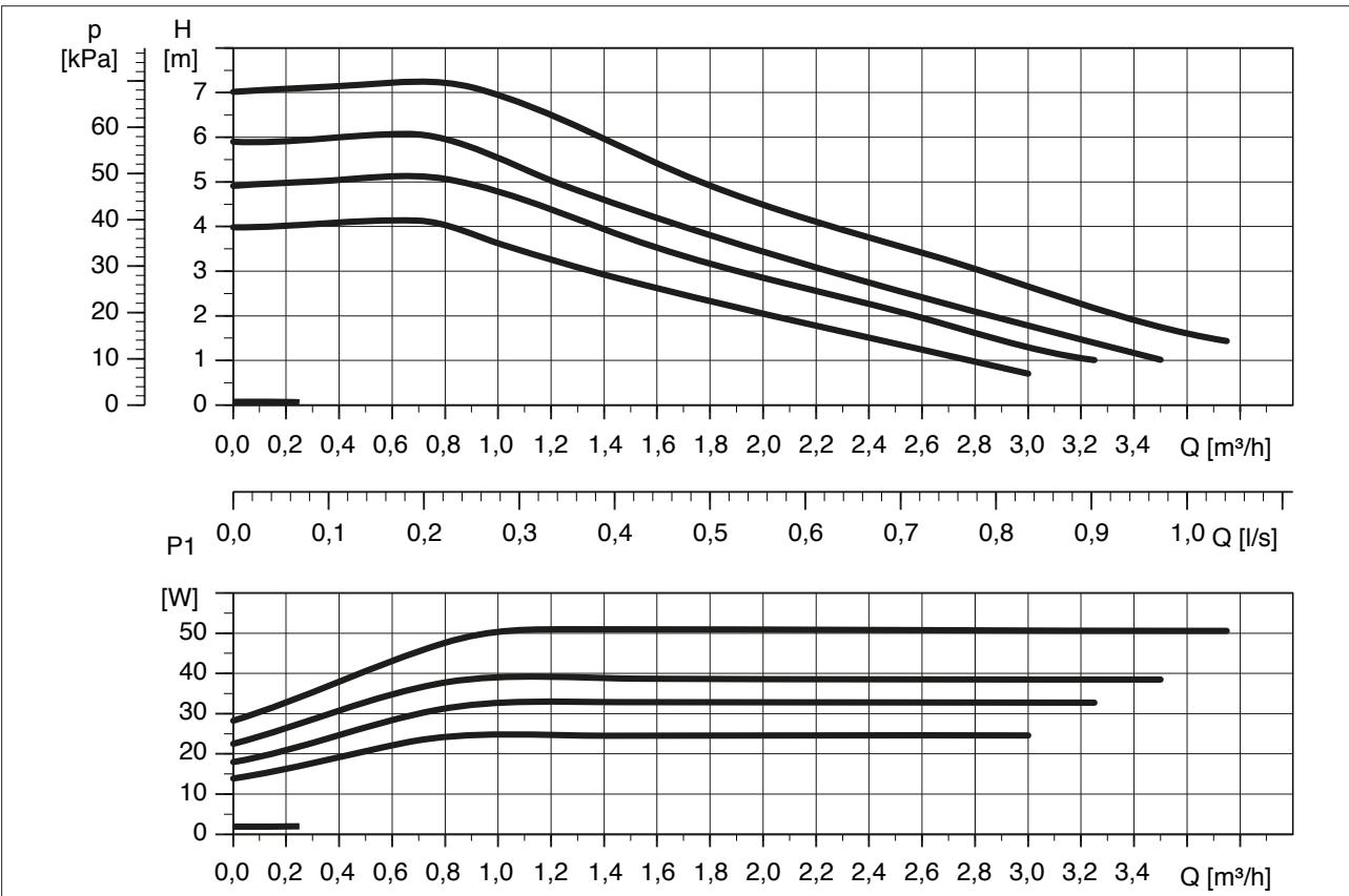
As curvas referem-se a uma densidade de 983,2 Kg/m<sup>3</sup> e uma temperatura de água de +20°C e ainda a uma viscosidade cinemática de 0,474 mm<sup>2</sup>/s (0,474 cSt).
