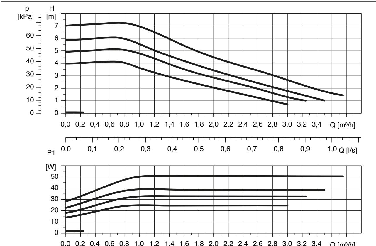
Las curvas se refieren a una densidad de 983,2 Kg/m³ y a una temperatura del agua de +20°C y también a una viscosidad cinemática de 0,474 mm²/s (0,474 cSt).
