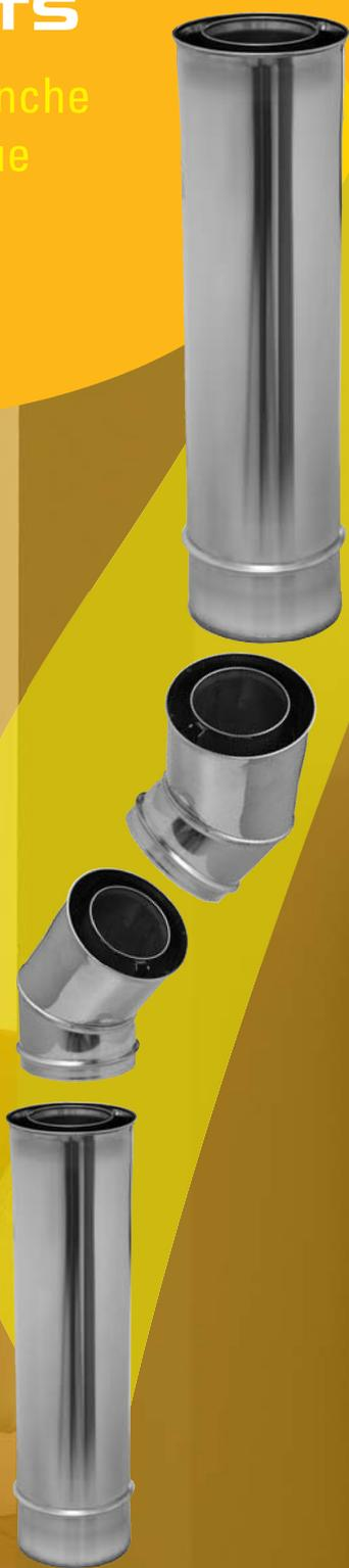
Le système DIFLUX PELLETS est un conduit concentrique qui permet simultanément l'évacuation des fumées et l'amenée d'air pour des poêles à granulés de bois (ou pellets). Il est particulièrement adapté dans l'habitat individuel. Il est conçu pour les poêles à granulés d'une puissance inférieure à 20 KW.
