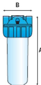
Montage:                        Sur tuyauterie horizontale, robinets à prévoir avant et après le filtre
