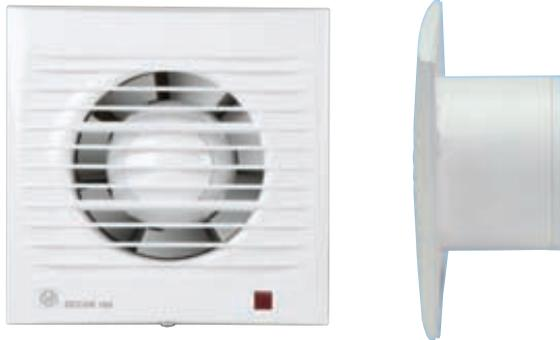
Ventilateurs hélicoïdes extra-plats, avec un débit d'environ 100 m<sup>3</sup>/h, clapet anti-retour incorporé, lampe témoin, moteur 230V-50Hz, IP44, Classe II, avec protection thermique, pour travailler à une température jusqu'à 40°C.
