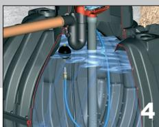
**étape 4** - L'eau de la cuve est prélevée et ré-filtrée à travers une crépine flottant à environ 10 cm sous la surface de l'eau. C'est à cette endroit que l'eau est la plus propre.
