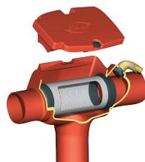
rehausse télescopique avec couvercle en PE passage piéton - couvercle PE avec sécurité enfants - accepte une correction de 5° pour permettre un ajustement au millimètre près avec la surface du terrain
