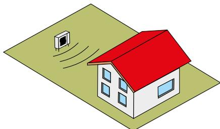
**Q = 4** : pompe à chaleur ou prise/sortie d'air (pour emplacement intérieur) le long d'un mur d'habitation
