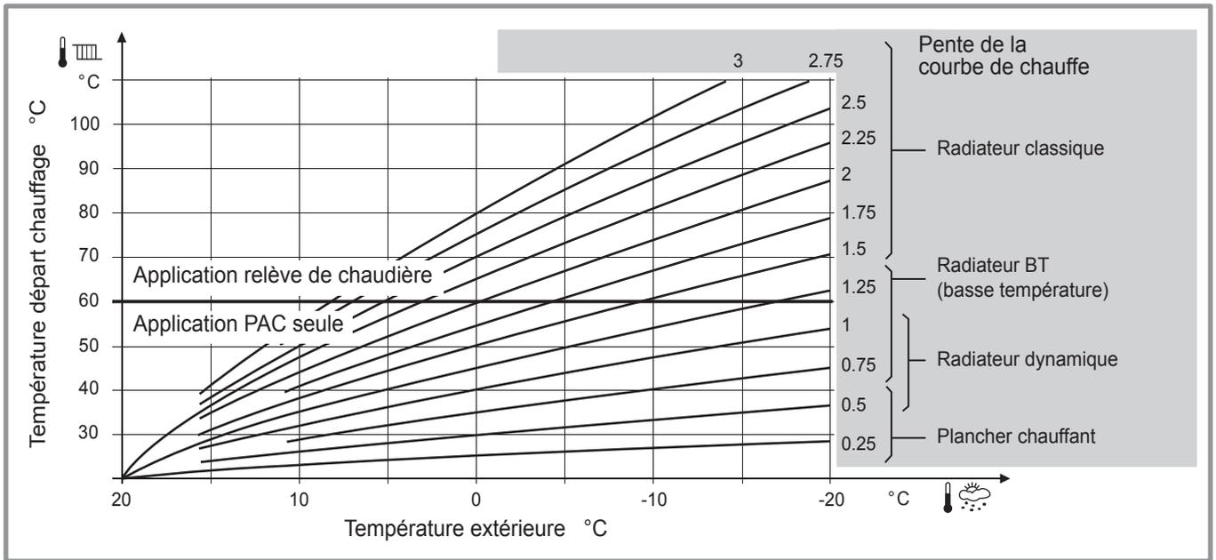
figure 48 - Pente de la courbe de chauffe
