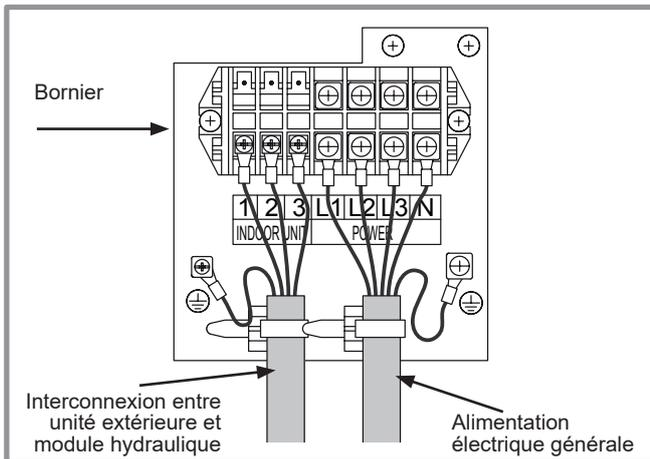
figure 38 - Connexions au bornier de l'unité extérieure triphasée
