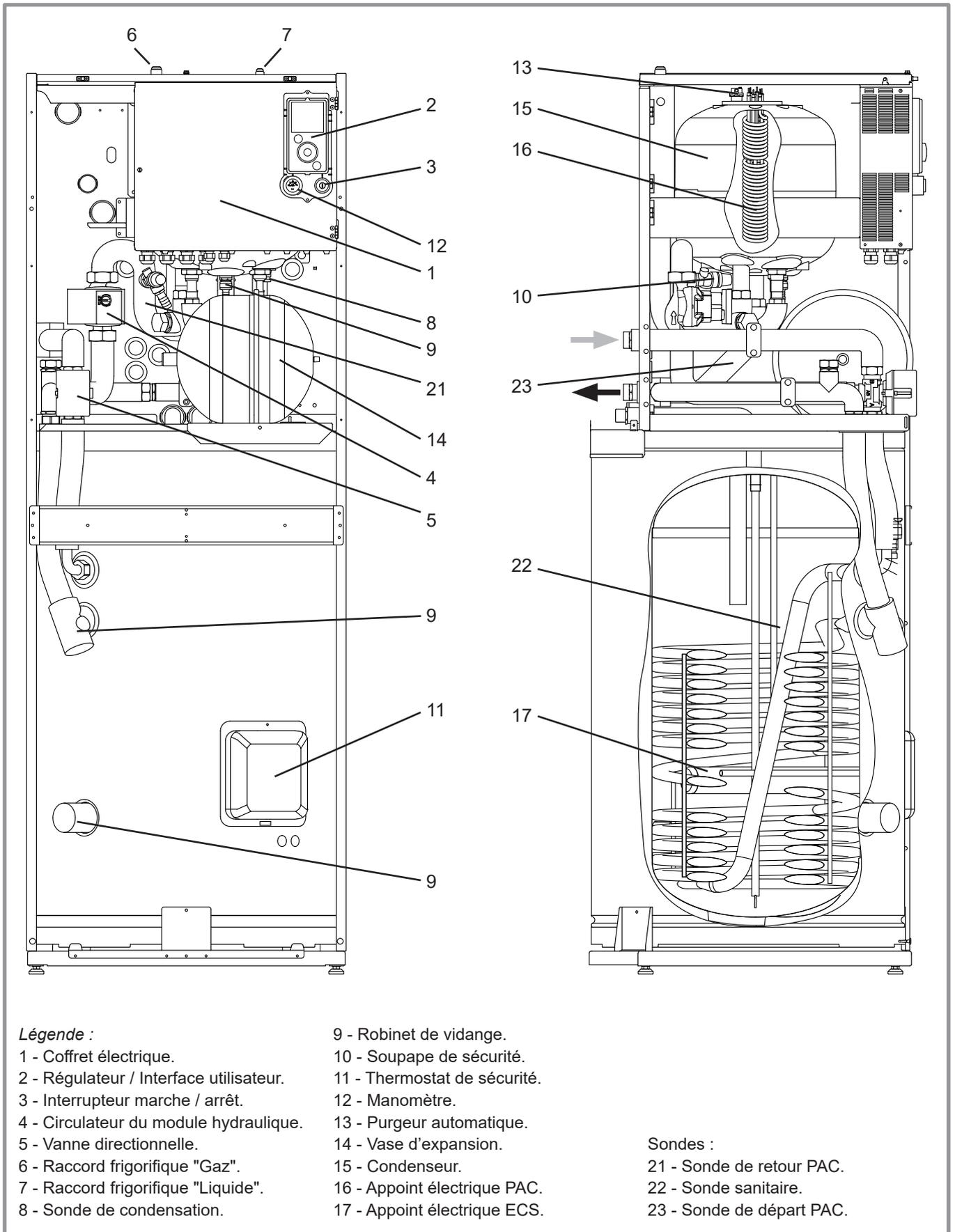
figure 9 - Organes du module hydraulique
