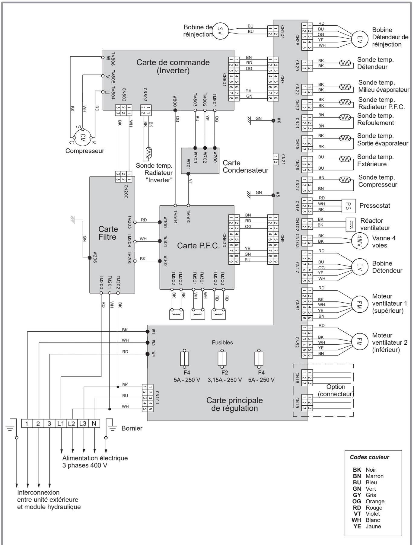
figure 52 - Câblage électrique unité extérieure modèle Alféa Excellia Duo A.I. triphasée
