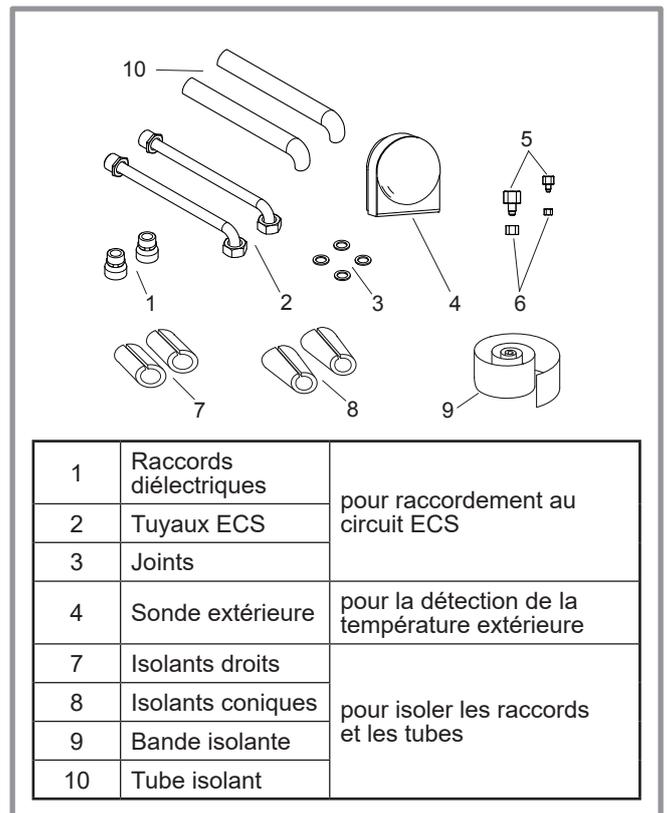
figure 4 - Accessoires fournis avec le module hydraulique
