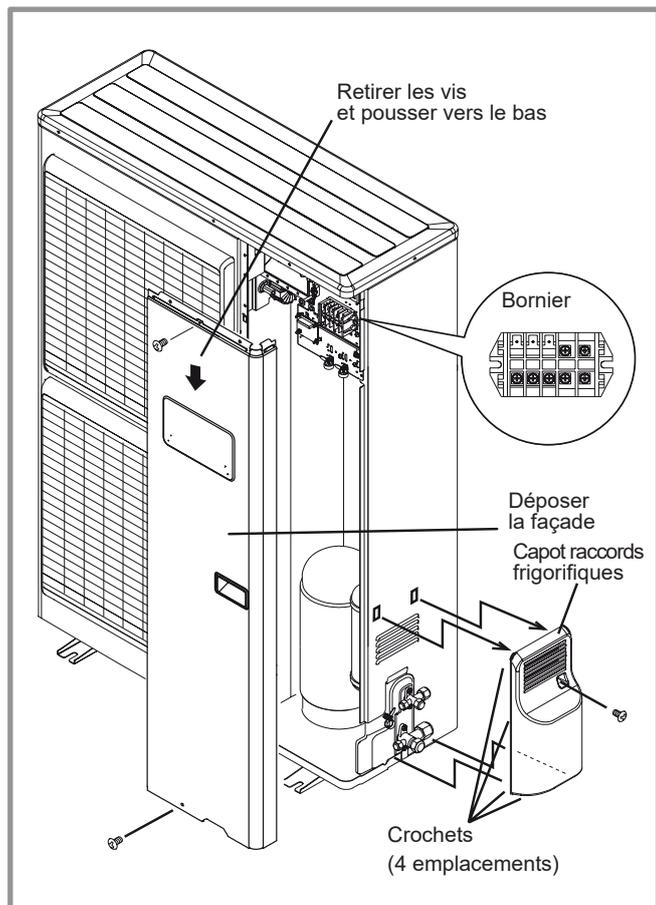
figure 34 - Accès au bornier de l'unité extérieure monophasée
