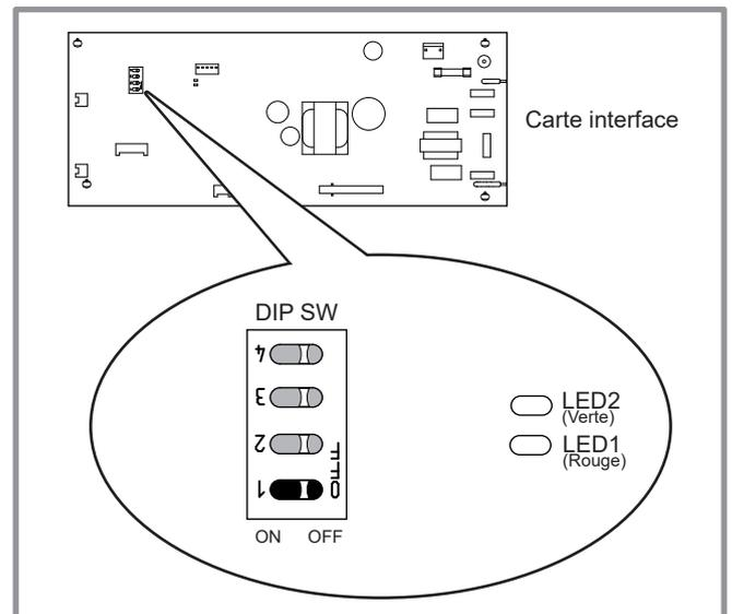
figure 24 - Emplacement des interrupteurs DIP et des diodes sur la carte d'interface du module hydraulique
