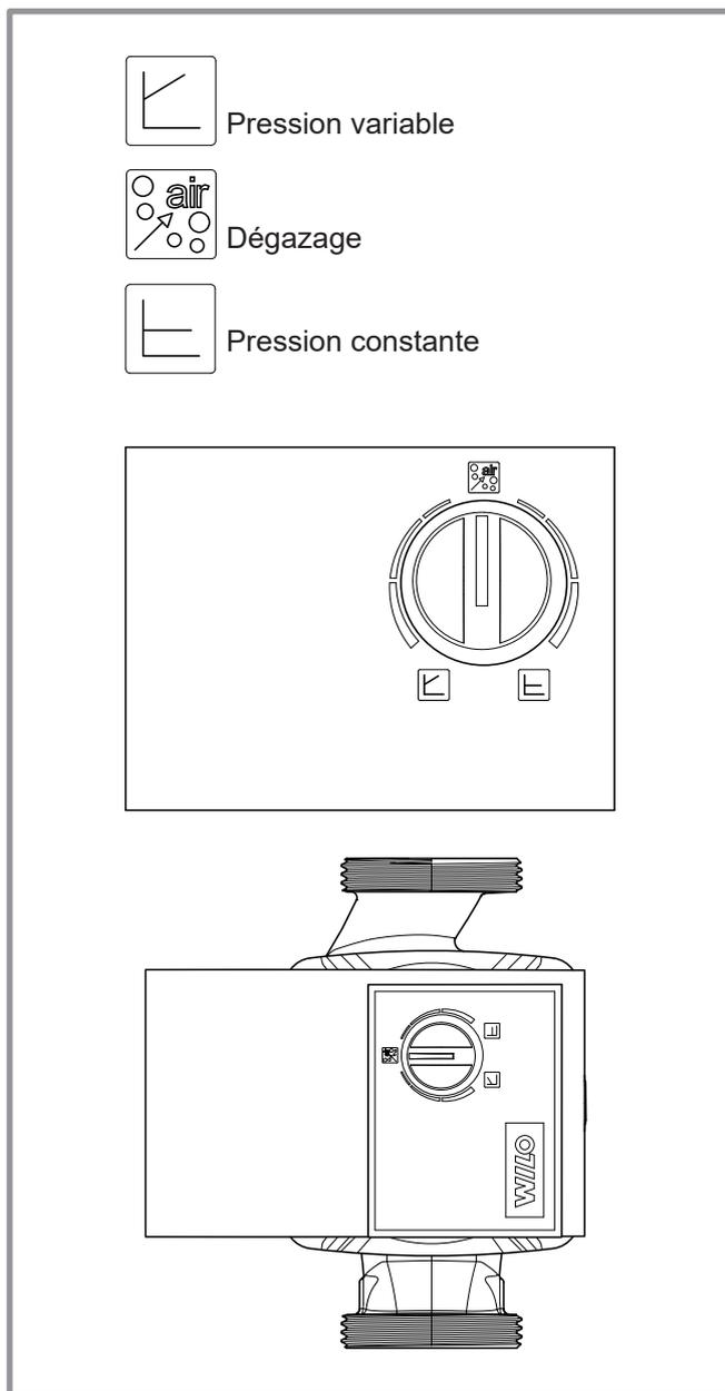
figure 32 - Bouton de réglage du circulateur
