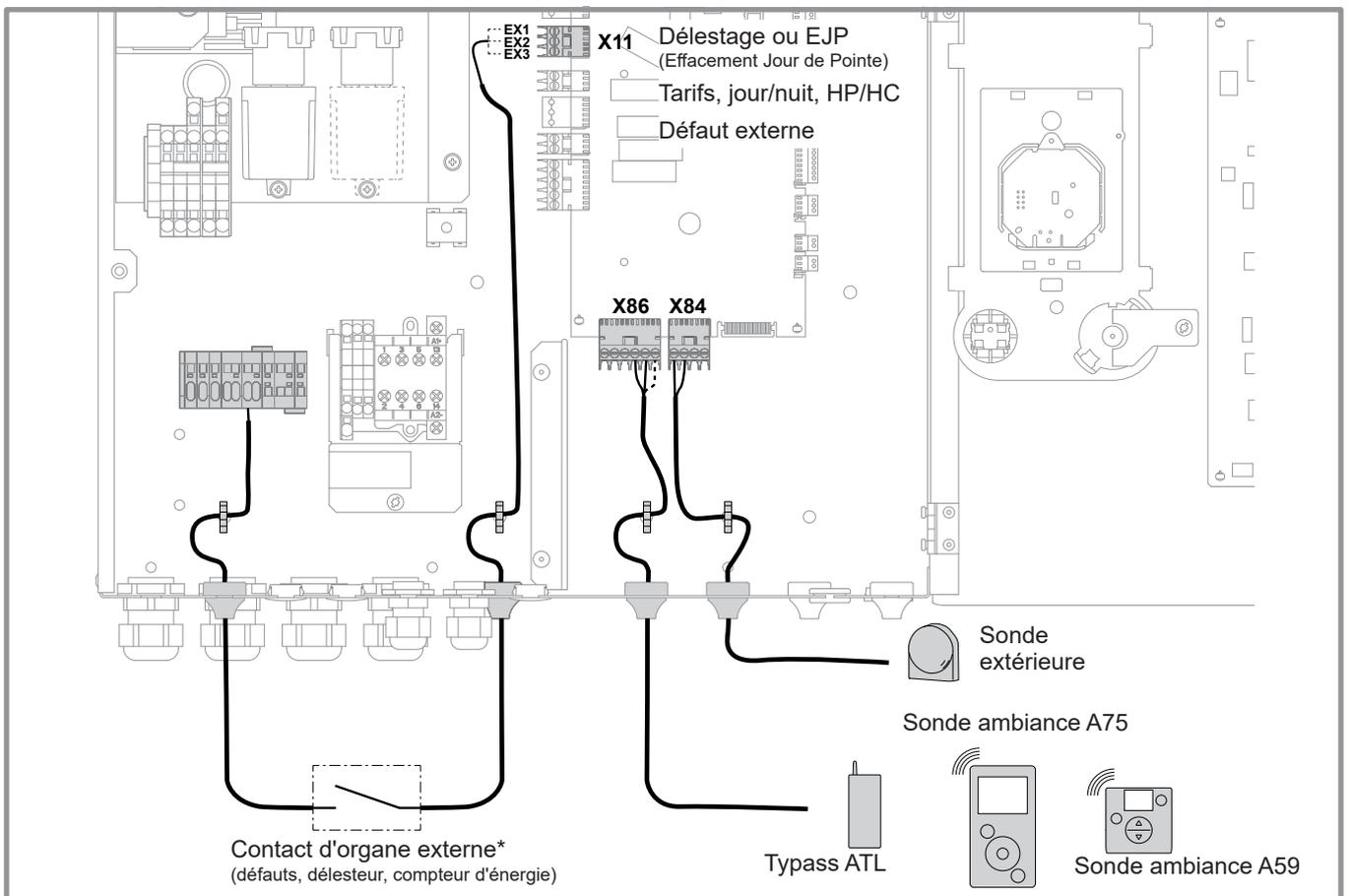
figure 45 - Passage des câbles des sondes
