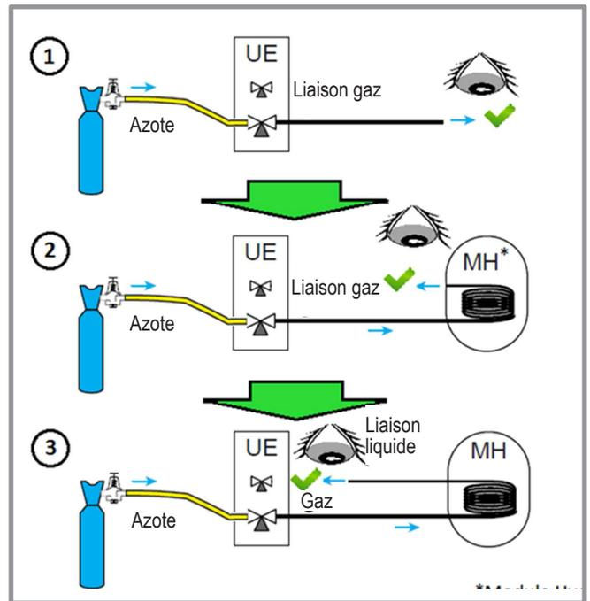
figure 21 - Vérification des liaisons frigorifiques
