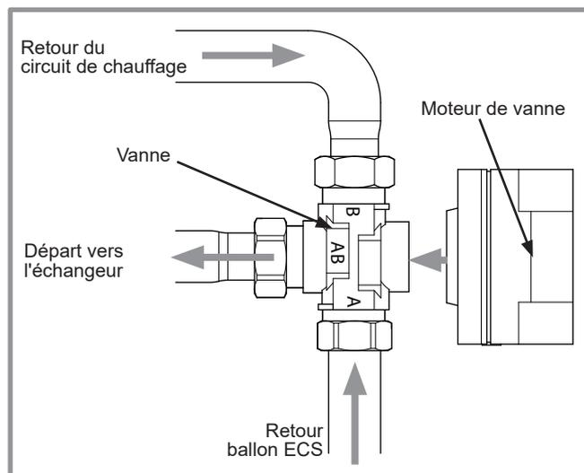
figure 56 - Montage de la vanne directionnelle
